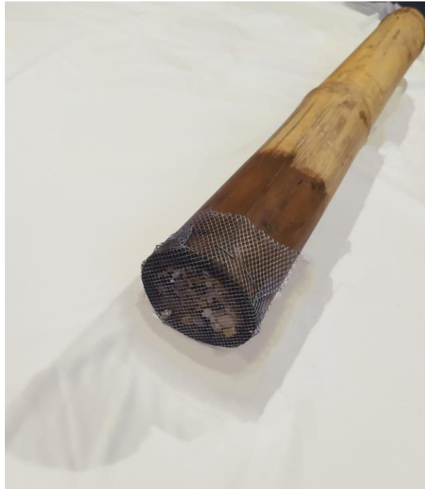
Figura 6. Prototipo final filtro a base de guadua y materiales de fácil acceso (elaboración propia)
