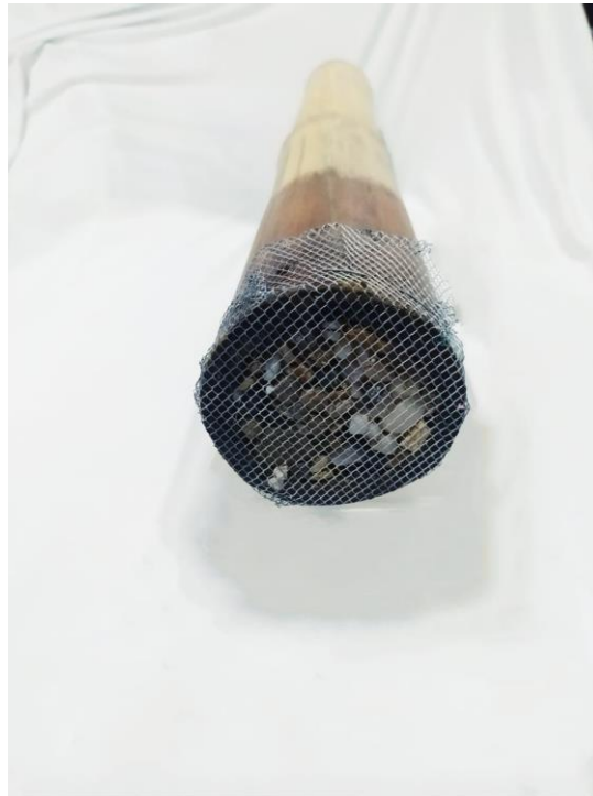
Figura 5. Prototipo final filtro a base de guadua y materiales de fácil acceso (elaboración propia)
