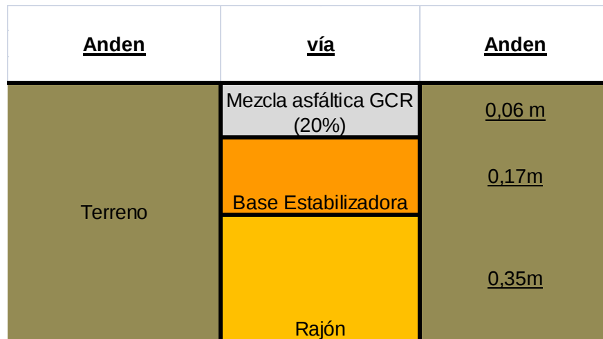
FIGURA 4. Sección tipo Pavimento Flexible
