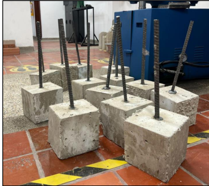
Figura 17: Instalación de barras corrugadas de ½"
