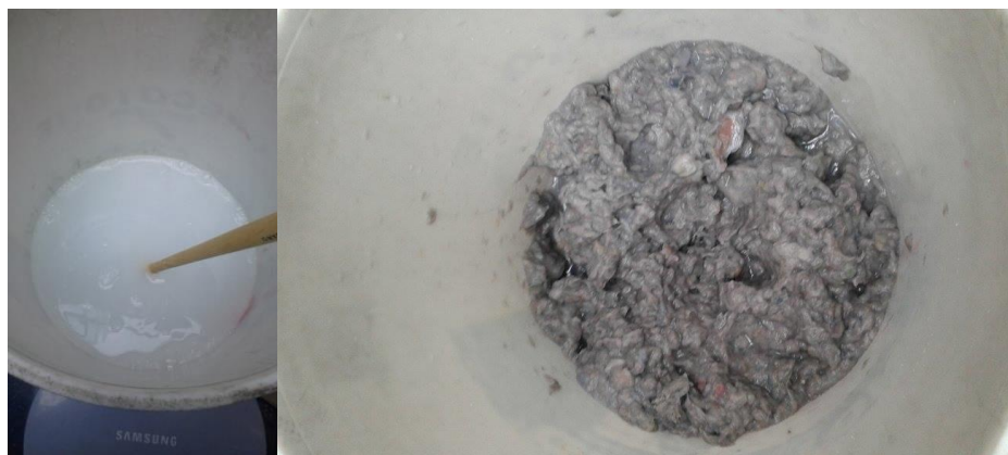
Ilustración 22. Solución adhesiva de agua y acetato de polivinilo PVA (Izq.) e inmersión de la pulpa de periódico en la misma. (Der.) Fuente: Elaboración propia (2015).
