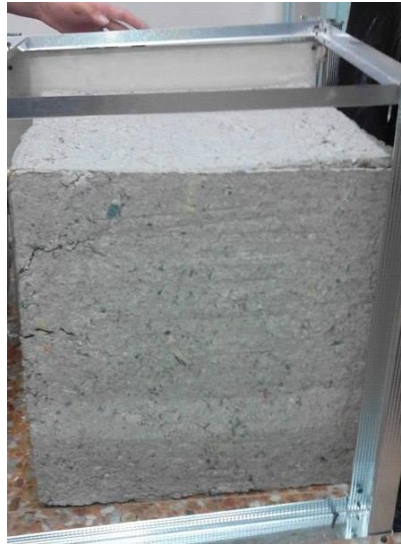
Ilustración 33. Cámara a escala de 0.25 metros cuadrados hecha con láminas de celulosa compactada. Fuente: Elaboración propia (2015).
