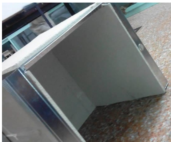
Ilustración 32. Cámara a escala de 0.25 metros cuadrados hecha con láminas de yeso-cartón de 50 cm x 50 cm. Fuente: Elaboración propia (2015).
