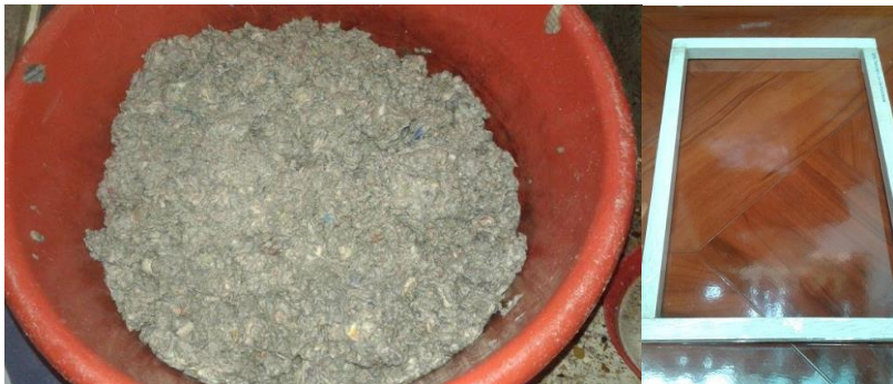
Ilustración 21. Pulpa de periódico durante el triturado (Izq.) y molde de compactación (Der.) Fuente: Elaboración propia (2015).
