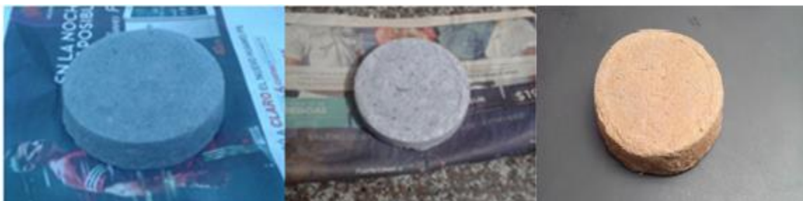
Ilustración 20. Probetas resultantes de la compactación de periódico (Izq.), bond (Cent.) y cartón (Der.) Fuente: Elaboración Propia (2015).
