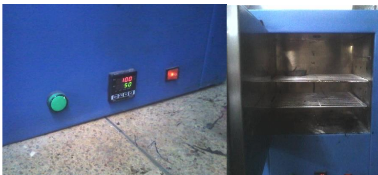
Ilustración 25. Secado en horno de la probeta con temperatura promedio de 50°C – 60°C. Fuente: Elaboración Propia. (2015)
