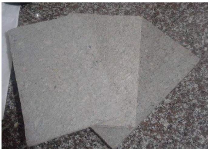
Ilustración 15. Prototipo de láminas Insucell Sheets de 8, 12 y 15 mm de espesor. Fuente: Elaboración Propia (2015).
