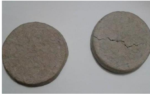
Ilustración 26. Probeta secada al horno (Izq.) y probeta secada a la intemperie. (Der.) Fuente: Elaboración Propia (2015)
