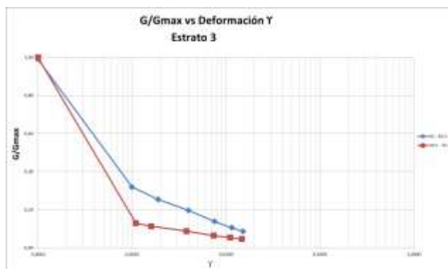
Figura 40. Curvas módulo de corte sin normalizar estrato 3. (38 – 50m.)
