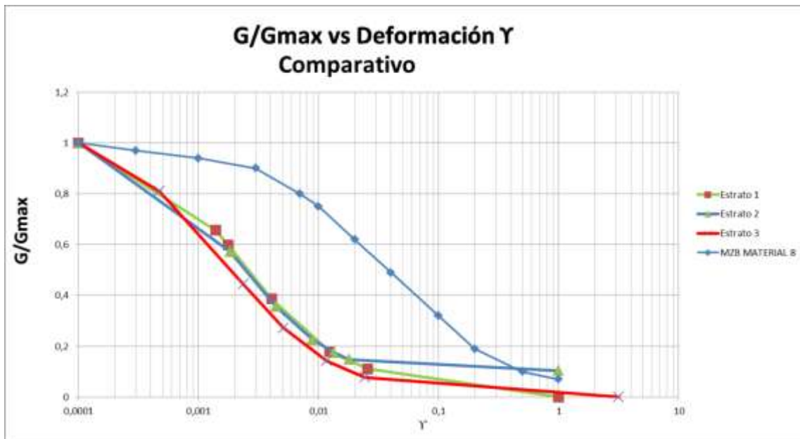
Figura 50. Gráfica comparativa curvas de degradación de módulo de corte Av. Boyacá con Av. Mutis
