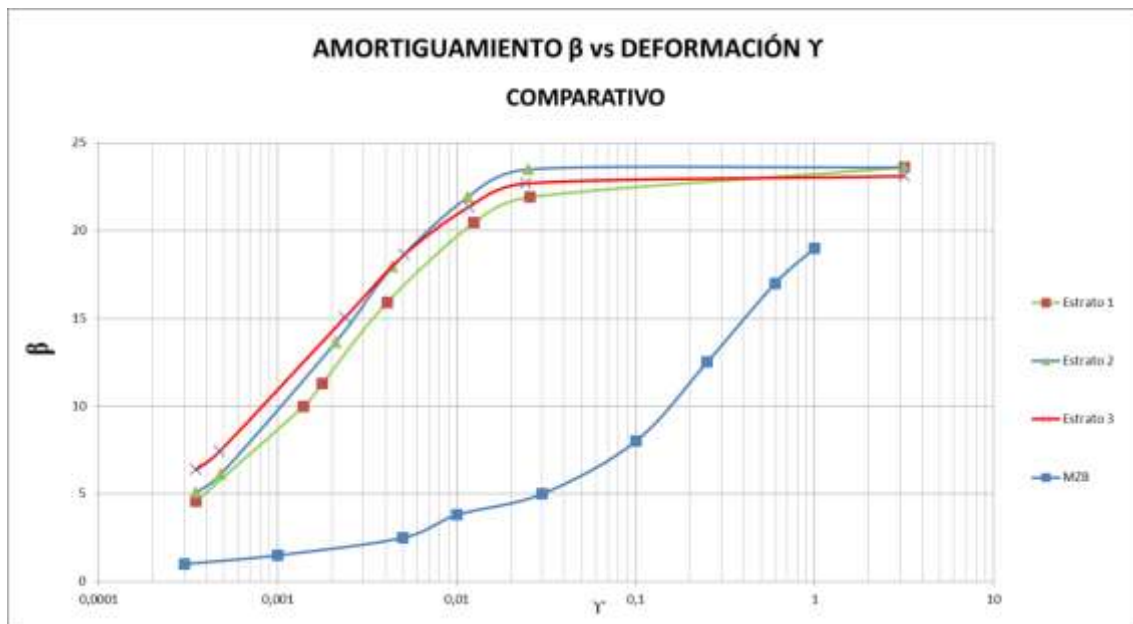
Figura 51. Gráfica comparativa curvas Amortiguamiento \beta vs Deformación Av. Boyacá con Av. Mutis
