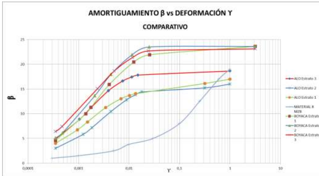
Figura 53. Comparación Amortiguamiento \beta vs Deformación \gamma
