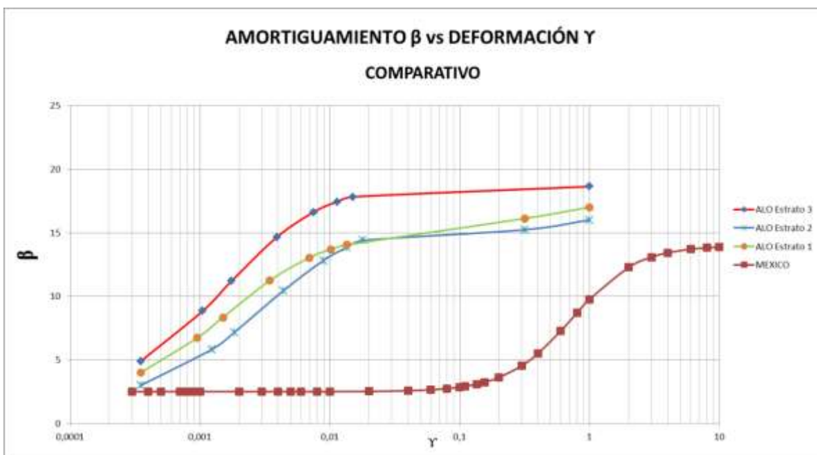
Figura 58. Gráfica Amortiguamiento vs Deformación
