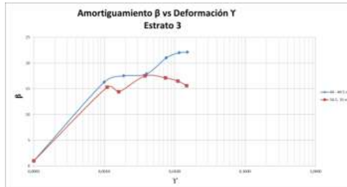
Figura 41. Curvas amortiguamiento sin normalizar estrato 3. (38 – 50m.)
