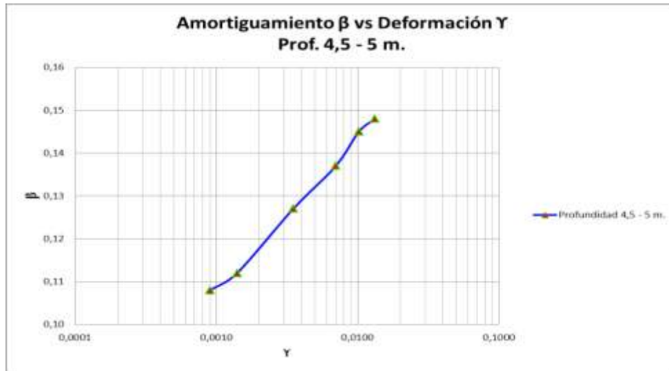
Figura 24. Gráfica de Amortiguamiento \beta Vs Deformación \gamma para 4.5 - 5 m de profundidad
