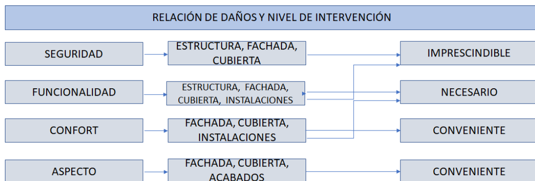
Figura2 Relación de daños y nivel de intervención (Ramírez, Castaño y López, 2009)
