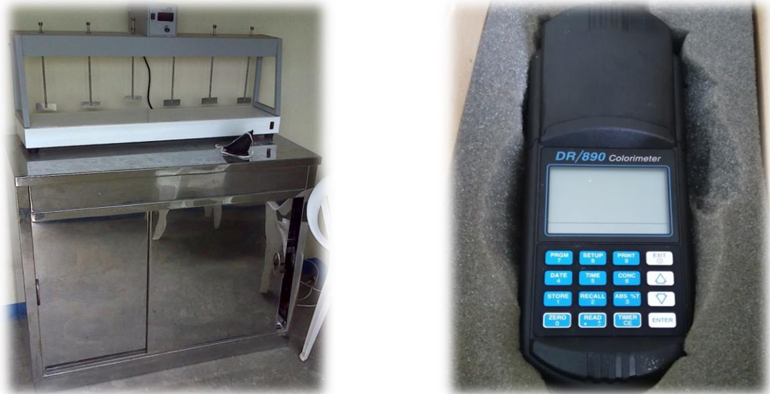
Figura 32. Equipo para realizar la prueba de jarras (izquierda) y Colorímetro para la medición de parámetros químicos (derecha).
