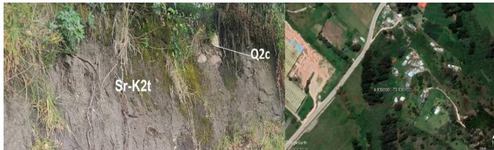
Figura 3-23. Afloramiento de depósitos coluviales (Q2c) supra yaciendo niveles residuales de la Formación Arenisca Tierna (Sr-K2t).
