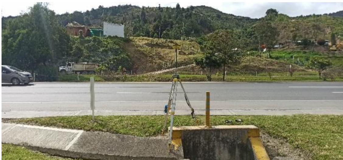
Figura 2-12. Estación base del IGAC Fuente: Propia.
