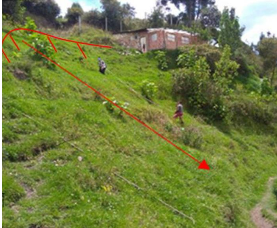
Figura 1-26. Coordenadas: E: 1016270, N: 1037594. Movimiento en masa de tipo rotacional. Vereda Canavita (Sector Patiño). Fuente: (GEOCING S.A.S, 2019)
