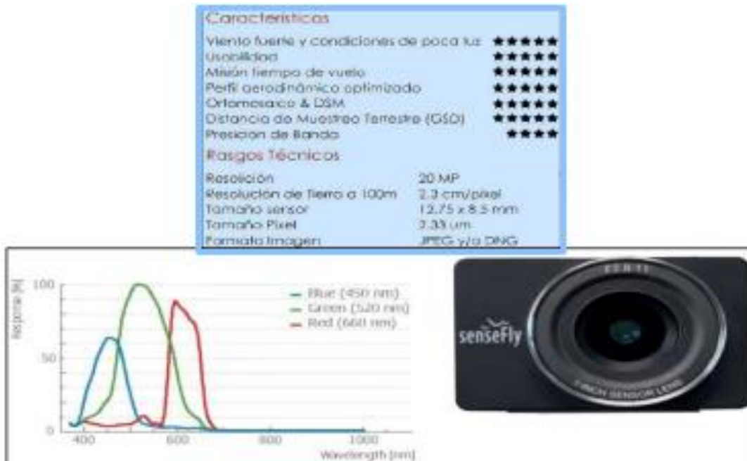
Figura 2-17. Especificaciones técnicas sensor. Fuente: GEOSPATIAL SAS.
