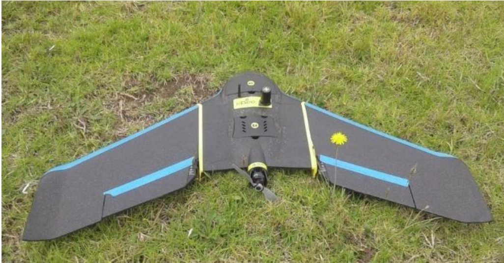
Figura 2-16. Drone eBee plus. Fuente: GEOSPATIAL SAS.
