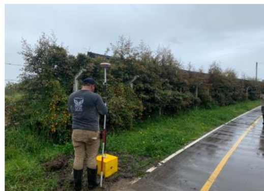
Figura 2-3. Punto de fotocontrol GCP - Mojón N° 13. Fuente: propia.
