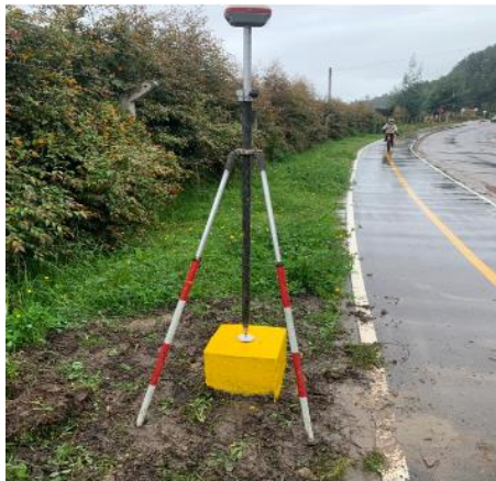
Figura 2-2. Punto de fotocontrol GCP - Mojón N° 12. Fuente: Propia.
