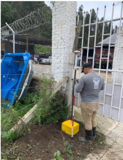
Figura 2-1. Punto de control GCP - Mojón N° 15 (Base). Fuente: Propia.
