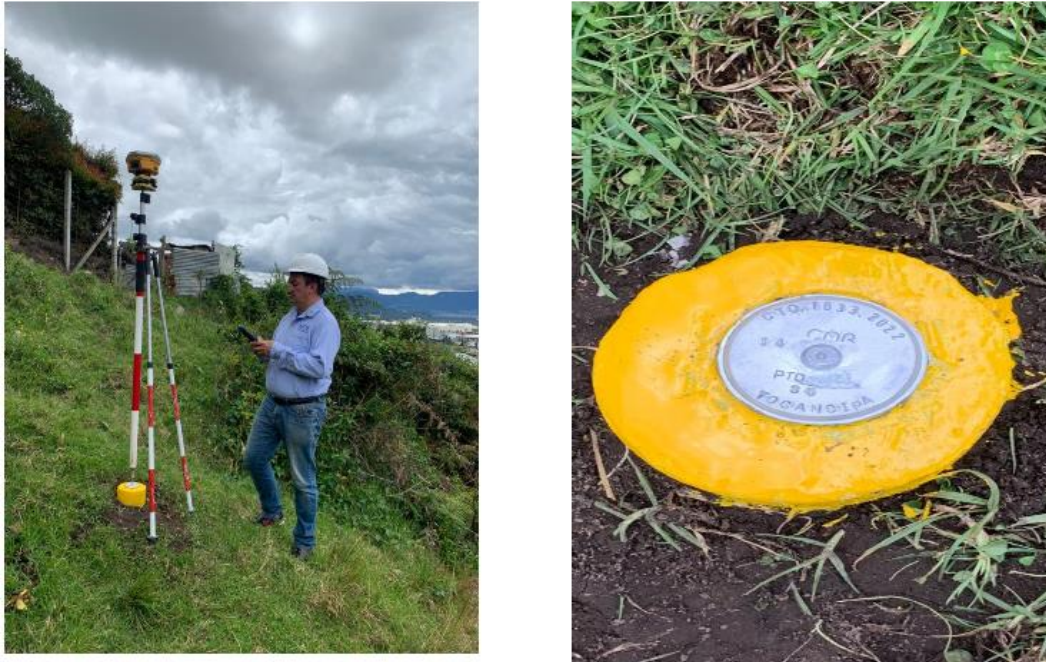
Figura 2-4. Punto de control GCP - Mojón N° 14. Fuente: Propia.
