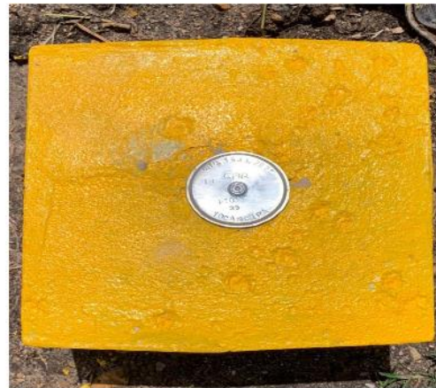
Figura 2-2. Punto de fotocontrol GCP - Mojón N° 12. Fuente: Propia.
