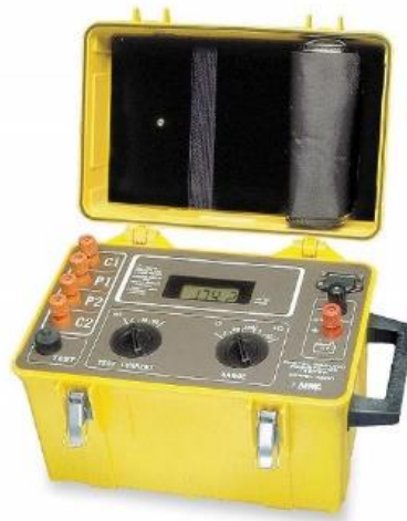
Figura 2-25. Medidor de resistencia AMEC 4500 Fuente: TERRA LABORATORIO E INGENIERIA S.A.S.
