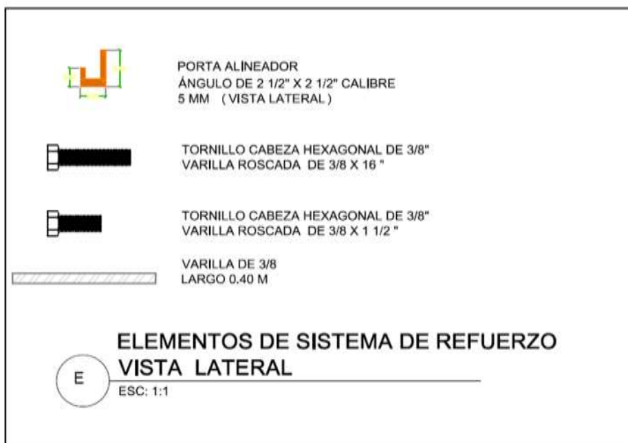
Figura 9. Elementos de sistema de refuerzo (Vista Lateral)
