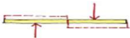
Imagen 13. Esfuerzo cortante lámina de guadua prensada
