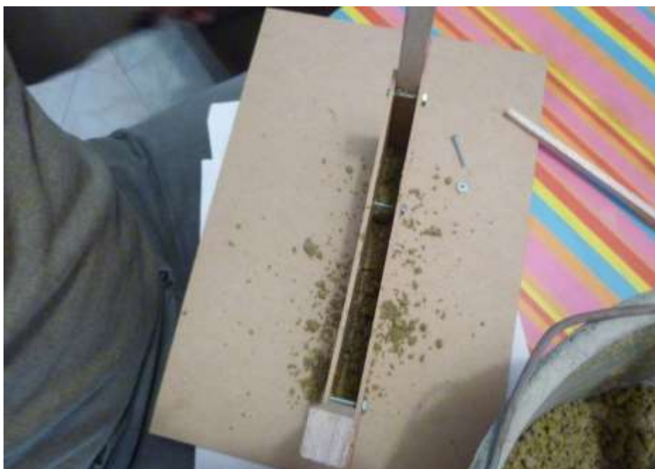
Imagen 25. Vertir tierra en el encofrado
