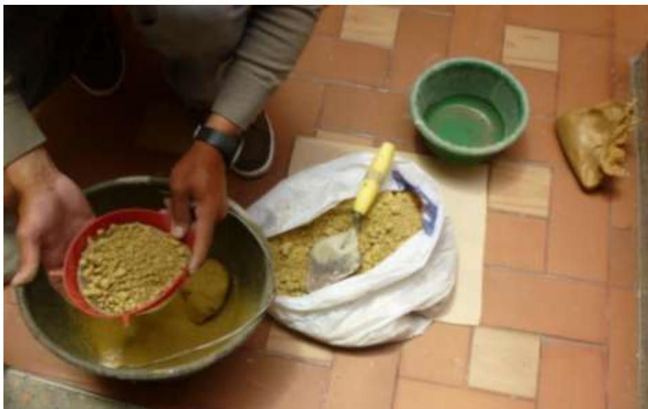
Imagen 22. Uso de material adecuado para la tapia pisada
