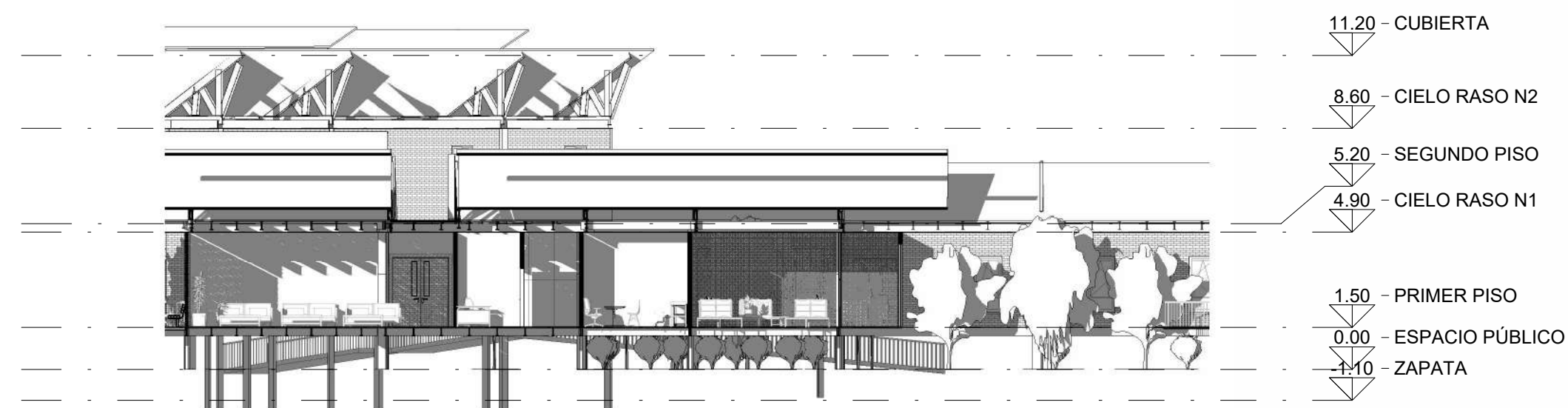
S CORTE LONGITUDINAL BLOQUE 3 1 : 200
