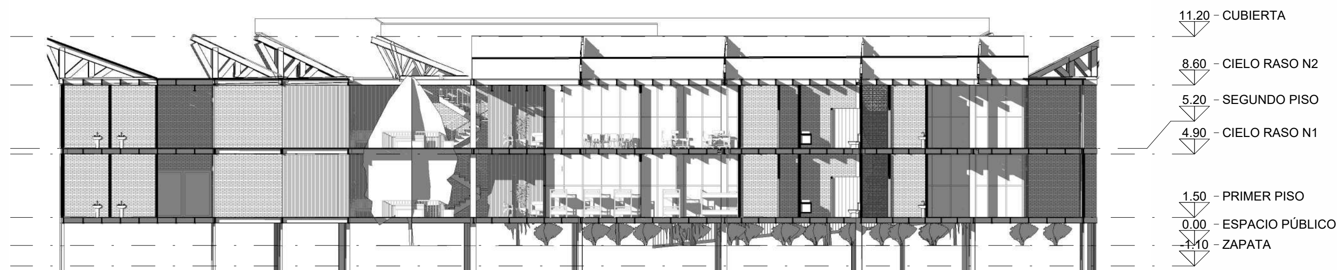
S CORTE TRANSVERSAL BLOQUE 2 1 : 200
