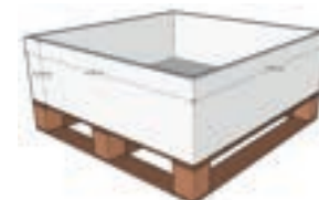
Cajón en Madera 1m x 1m x 0.30m
