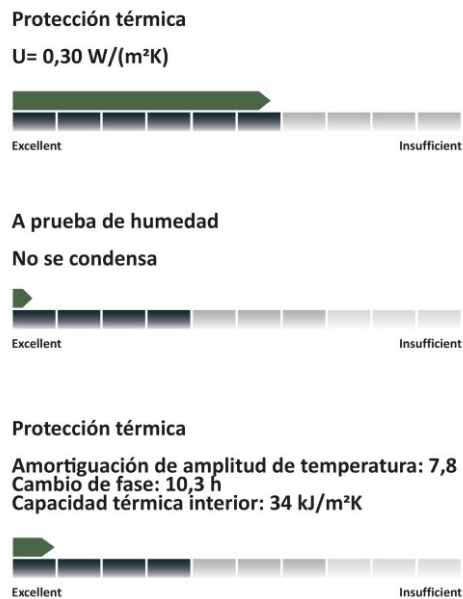
Figura 40. Resultados de aislamiento de la muestra M3
