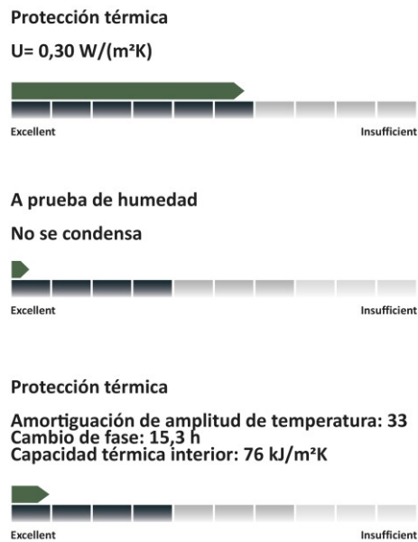
Figura 44. Resultados de aislamiento de la muestra M1
