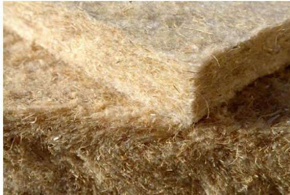
Figura 28. Panel aislante de cáñamo, térmico y acústico
