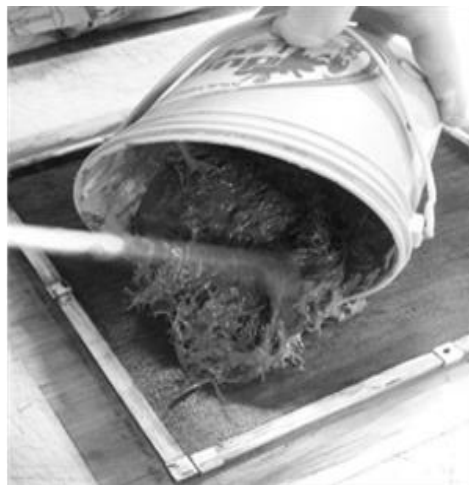
Figura 16. Vertido de la mezcla sobre el molde aceitado. Elaboración propia.
