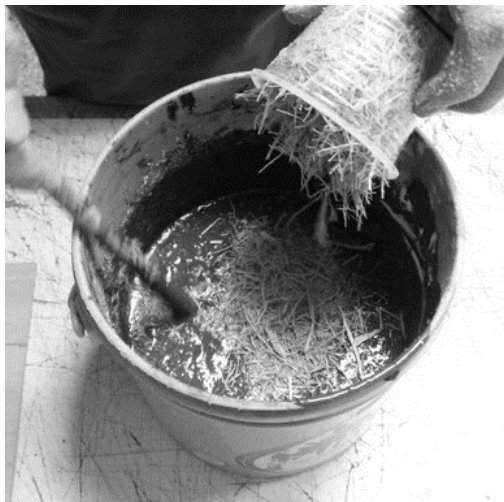
Figura 14. Adición de las fibras de bagazo de caña a la mezcla de cemento/melaza. Elaboración propia.
