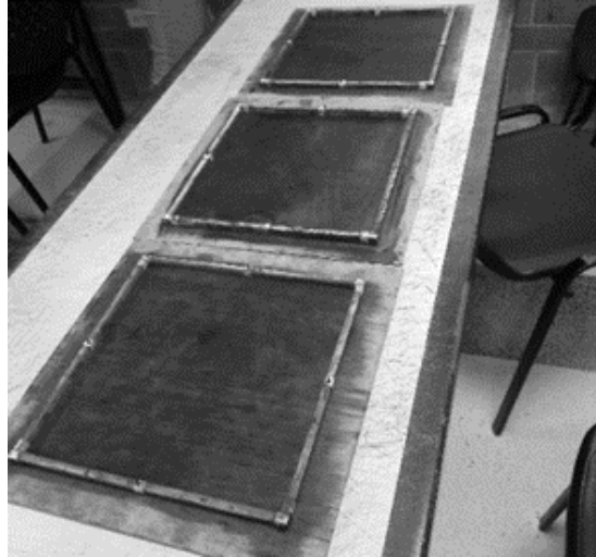
Figura 19. Juego de moldes limpio y listo para usarse en la siguiente fundición. Elaboración propia.
