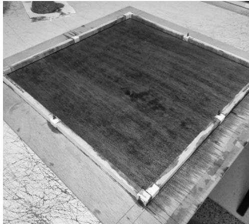
Figura 15. Molde de madera al que se le aplicó aceite quemado. Elaboración propia.
