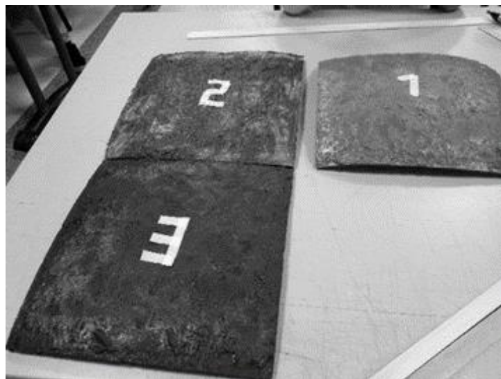
Figura 20. Primer juego de paneles secándose en sombra durante 8 días. Elaboración propia.
