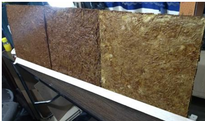
Figura 26. Juego 2 de paneles. Se muestran los paneles con las dosificaciones que mostraron los mejores resultados aislantes y su acabado de color marrón- ámbar. Elaboración propia.
