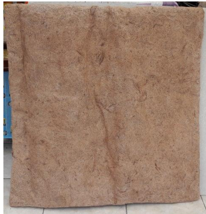
Ilustración 23. Lamina de fibra de coco de mayor densidad. Fuente: Elaboración propia (2016)
