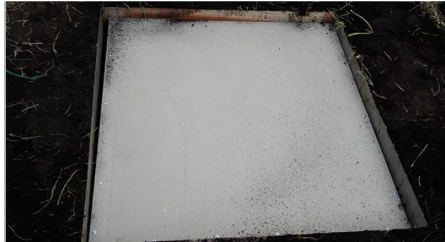
Ilustración 66: Panel después de ensayo de aislamiento acústico. Fuente: Elaboración Propia (2016)
