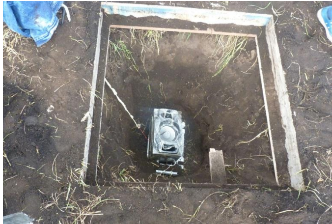
Ilustración 40: Bafle para ensayos de laboratorio el cual transmitía una fuente de sonido rosa. Fuente: Elaboración propia (2016)
