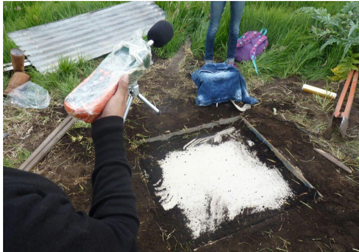
Ilustración 42: Ensayo del prototipo con un sonómetro a una altura de 1.20m. Fuente: Elaboración Propia (2016)
