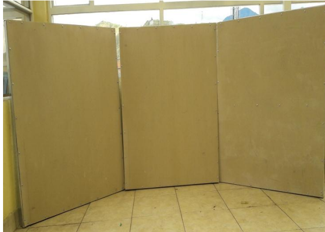
Ilustración 25. Prototipos de Fico-panel primer prototipo sin relleno, segundo prototipo con lamina de fibra de coco de menor densidad, tercer prototipo con lamina de fibra de coco de mayor densidad. Fuente: Elaboración propia (2016).
