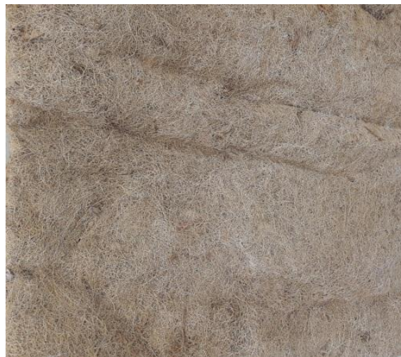
Ilustración 22. Lamina de fibra de coco de menor densidad. Fuente: Elaboración propia (2016)
