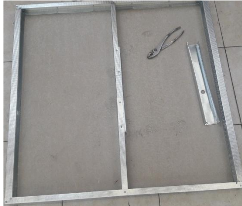
Ilustración 12. Entramado de fibrocemento de 4mm y perfiles de acero galvanizado sin material de relleno. Fuente: Elaboración propia (2016)
