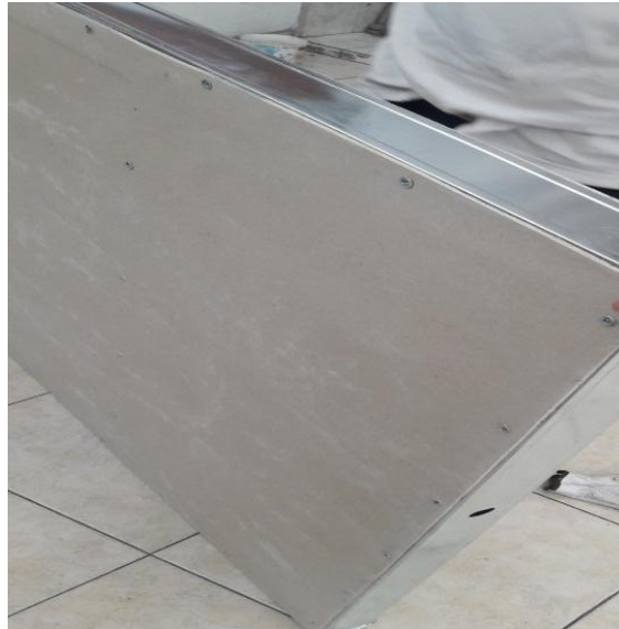
Ilustración 19: Entramado de fibrocemento 4mm perfiles de acero galvanizado, lamina de coco de mayor densidad. Fuente: Elaboración propia (2016)
