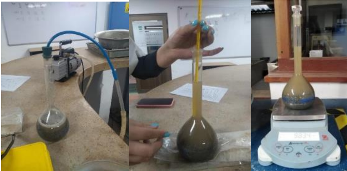
Figura 13 Extracción de burbujas, toma de temperatura y peso de la masa. Elaboración Propia.
