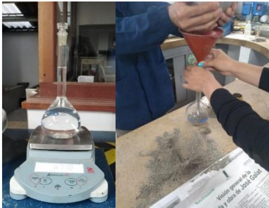
Figura 12 Picnómetro, más la muestra y agua. Elaboración propia
