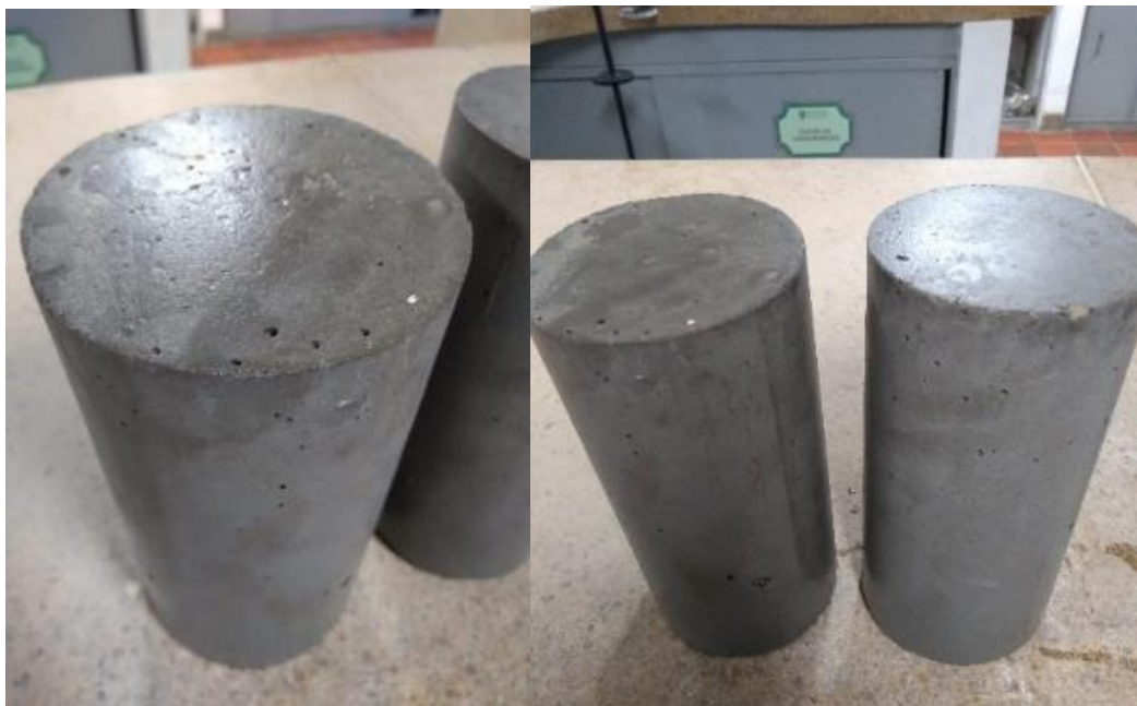
Figura 39 Cilindros luego del proceso del curado de 7 días. Elaboración propia
