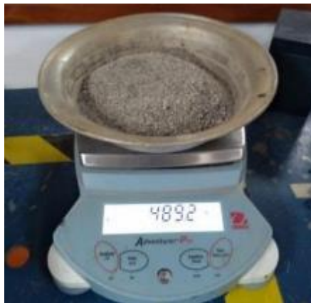
Figura 14 Masa en el aire de la muestra secada al horno. Elaboración propia.
