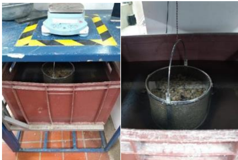
Figura 9 Determinación masa saturada en agua. Elaboración propia.
