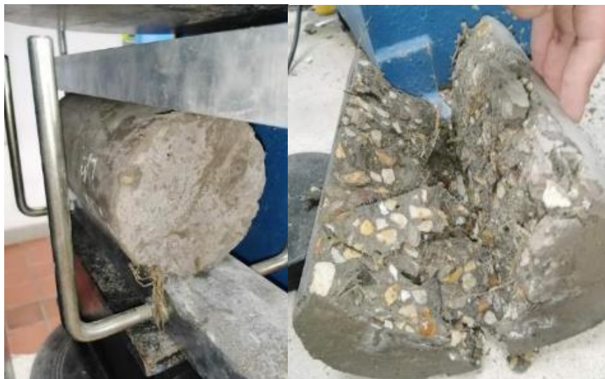
Figura 52 Falla de cilindro tipo 1 a tensión a los 14 días. Elaboración propia
