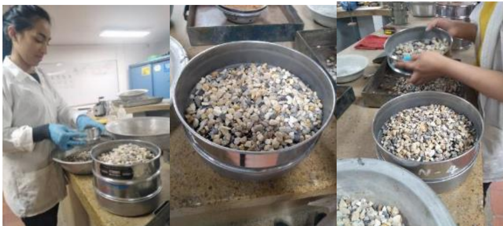
Figura 20 Tamizado de agregado grueso. Elaboración propia.
