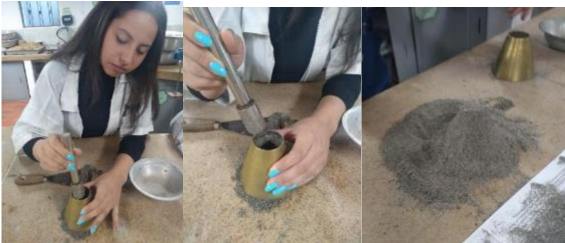
Figura 11 Cono para determinar la humedad superficial. Elaboración Propia
