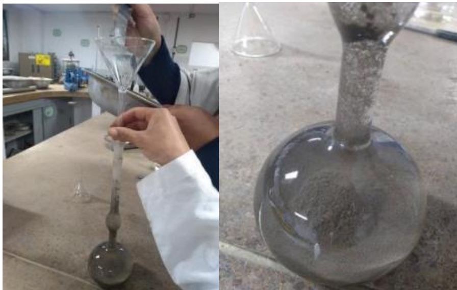
Figura 5 Frasco de Le Chateriel con adición de cemento. Elaboración Propia
