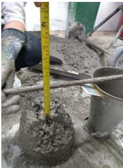
Figura 35 Asentamiento mezcla tipo 2. Elaboración propia.
