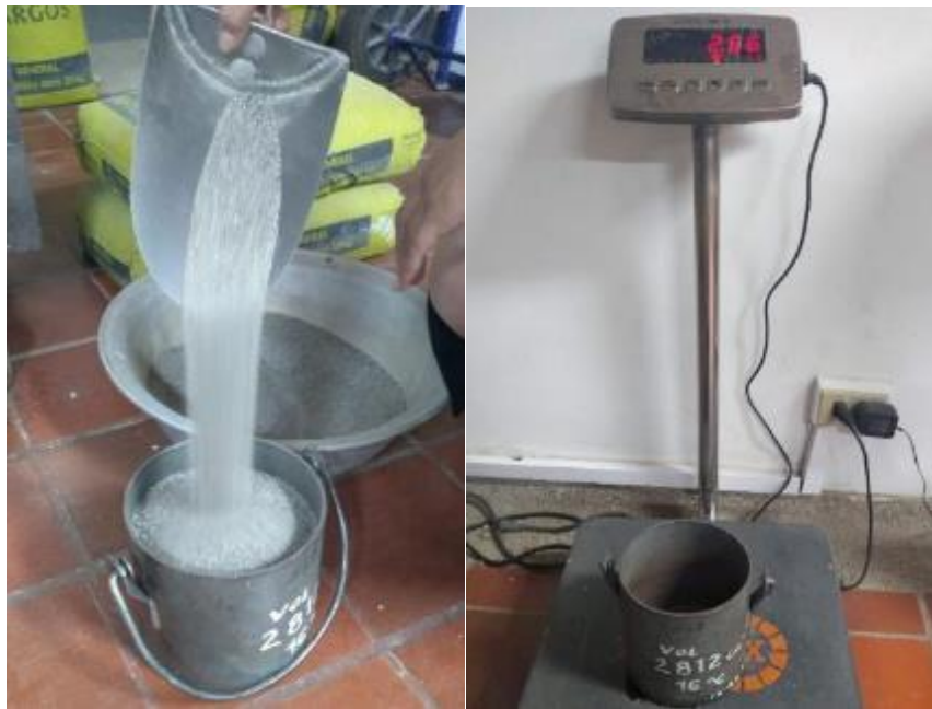
Figura 18 Procedimiento por paleo y peso del molde. Elaboración propia
