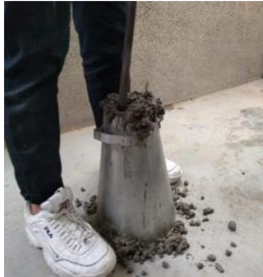
Figura 32 Proceso de asentamiento del concreto muestra patrón. Elaboración propia.
