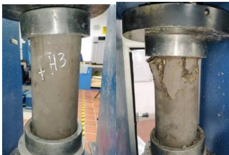
Figura 46 Falla a compresión cilindro fibra húmeda a los 14 días. Elaboración propia
