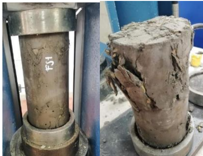
Figura 43 Falla a compresión cilindro Fibra seca a los 7 días. Elaboración Propia
