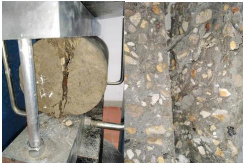
Figura 54 Falla a tensión cilindro tipo 2 a los 14 días. Elaboración propia
