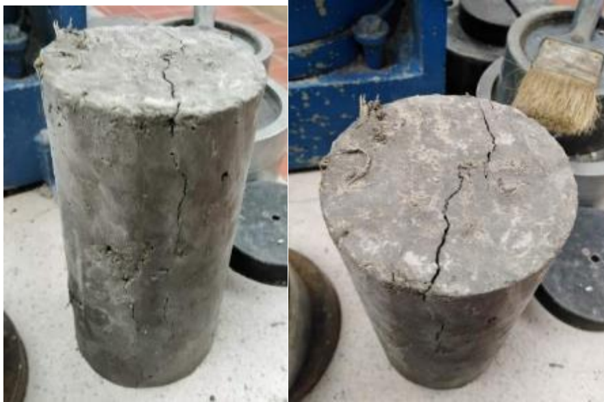
Figura 51 Falla de cilindro tipo 1 a tensión a los 7 días. Elaboración propia.
