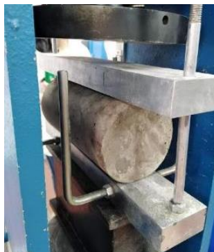
Figura 48 Cilindro colocado para Ensayo a tensión indirecta. Elaboración propia
