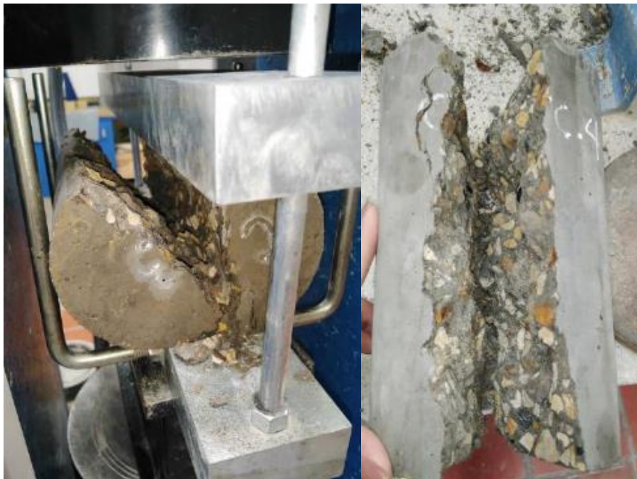
Figura 50 Falla de cilindro patrón a tensión a los 14 días. Elaboración propia.
