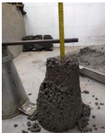
Figura 33 Asentamiento de mezcla patrón. Elaboración propia
