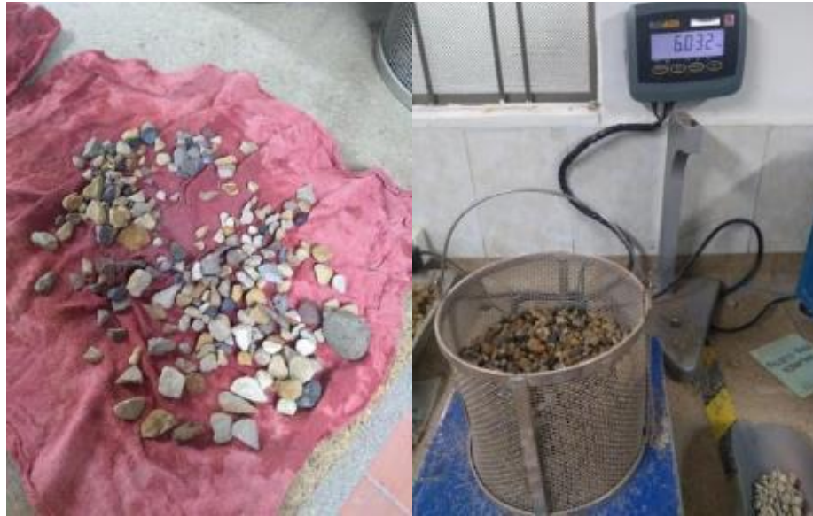
Figura 8 Determinación condición superficialmente seca. Elaboración propia.
