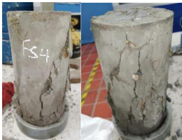
Figura 44 Falla a compresión cilindro Fibra seca a los 7 días. Elaboración propia.
