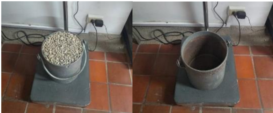
Figura 15 Masa y molde del agregado grueso. Elaboración propia
