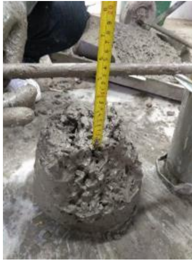
Figura 34 Asentamiento mezcla tipo 1. Elaboración propia.
