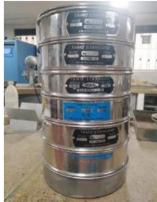
Figura 19 Tamices para el agregado grueso. Elaboración propia.
