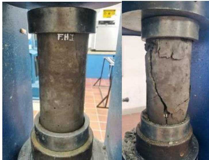
Figura 45 Falla a compresión cilindro fibra húmeda a los 7 días. Elaboración propia
