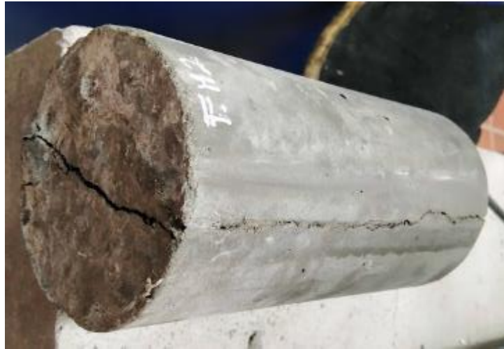
Figura 53 Falla a tensión cilindro tipo 2 a los 7 días. Elaboración propia
