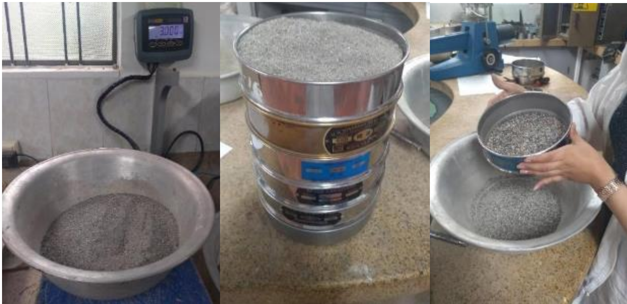
Figura 22 Tamizado de agregado fino. Elaboración propia
