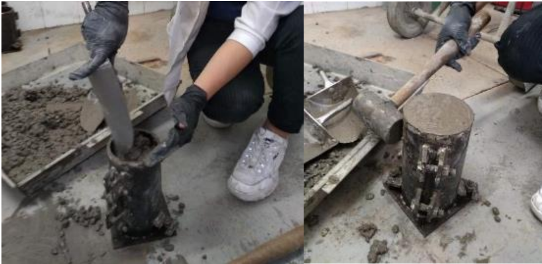
Figura 36 Vibrado del concreto. Elaboración propia
