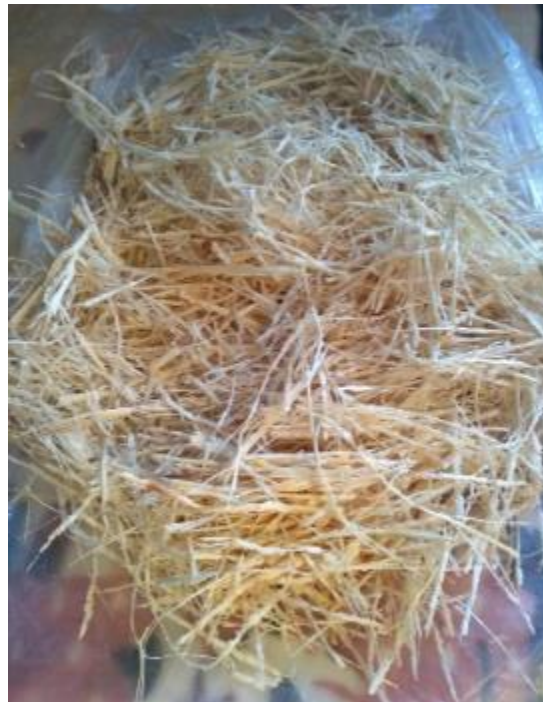
Figura 27 Fibras de caña de azúcar. Elaboración propia.
