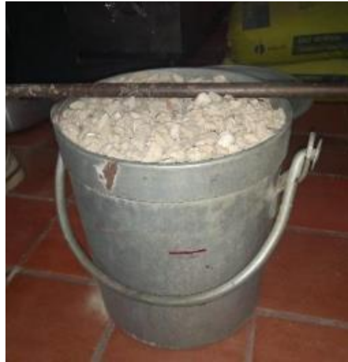
Figura 16 Nivelación muestra después de llena. Elaboración propia
