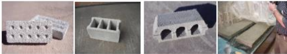
Figuras 1 a 4: productos fabricados con PET reciclado en CEVE – CONICET
