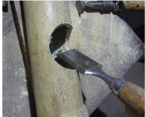
Ilustración 14 Perfeccionamiento con formón o escoplo
