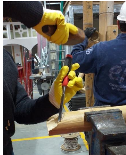
Ilustración 4 Proceso constructivo - terminación de corte tipo flauta con copa
