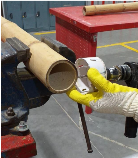
Ilustración 2 Proceso constructivo - corte tipo flauta con copa
