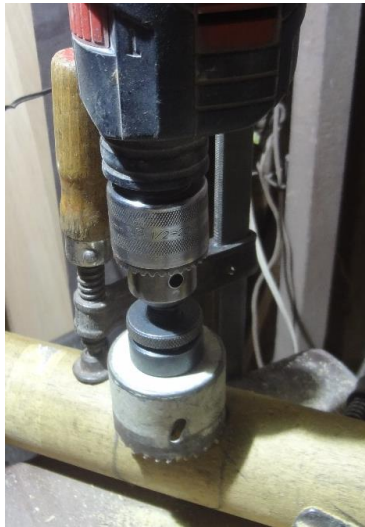
Ilustración 13 Perforación a guadua con copa sierra
