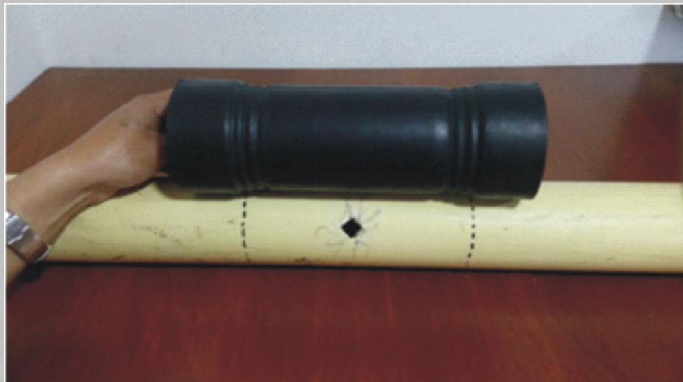
2. Se realiza el ensamble de la tubería, en una longitud de 100 cm.
