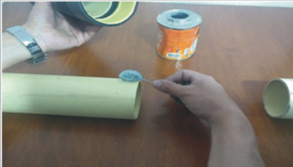
5. Se realiza el ensamble de la tubería, en una longitud de 100 cm.
