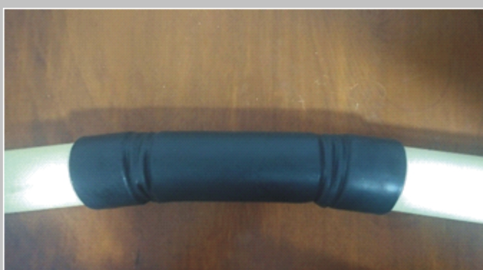
8. Se realiza el ensamble de la tubería, en una longitud de 100 cm.
