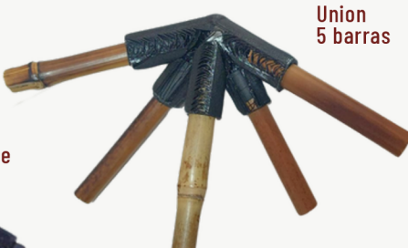
MATERIALIDAD Unión de filamento con barra de Bambu
