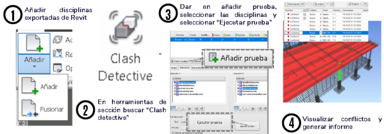
Figura 38 Detección de interferencias en Navisworks
