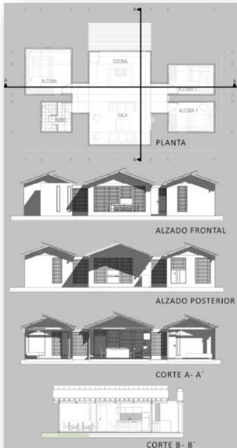
Ilustración 49 Corte Fachada Módulo (Agulelo & DiazdelCastillo , 2014)
