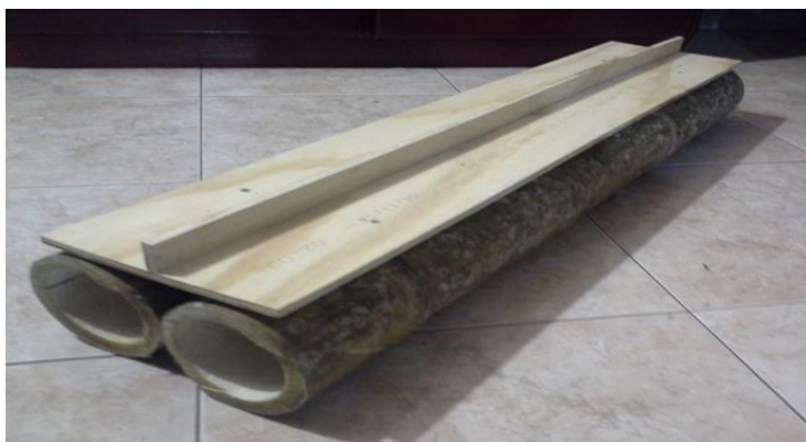
Imagen 37. Vigas en guadua.
