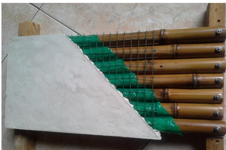
Imagen 16. Panel prefabricado con losa en concreto, escala 1:2.
