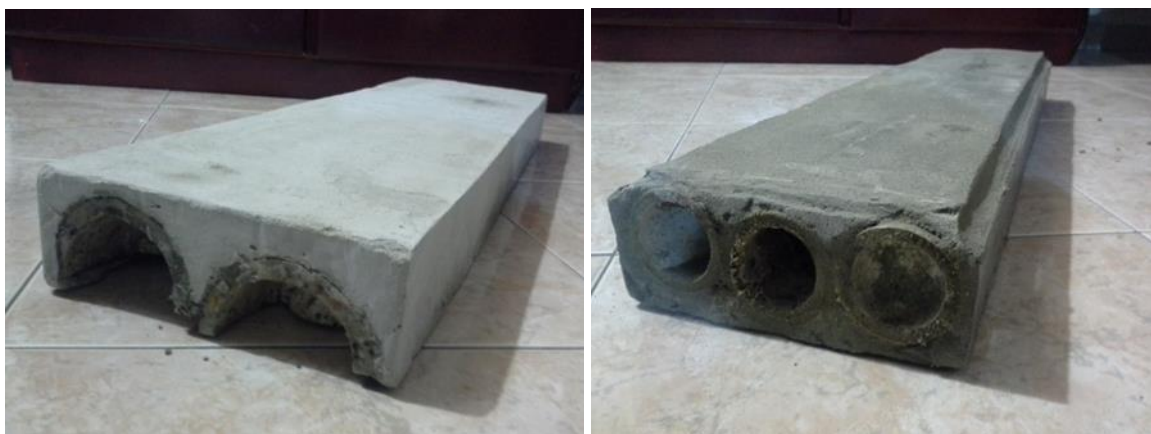
Imagen 17. Paneles tipo I (media guadua) y tipo II (guadua embebida).
