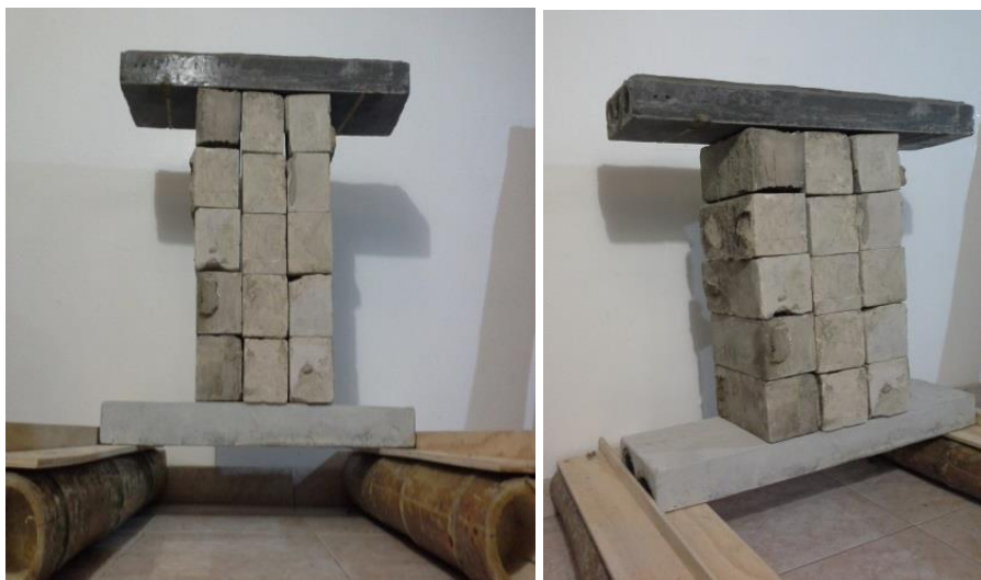
Imagen 34. Peso que soporto el panel tipo I.
