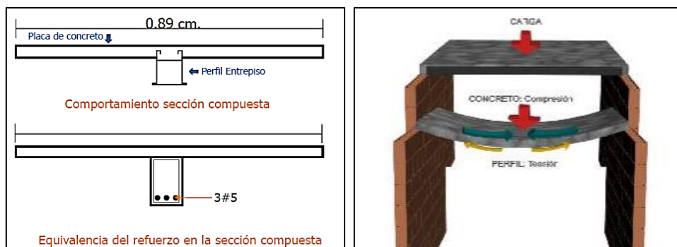
Figura 32: Trabajo del sistema de entrepiso.
