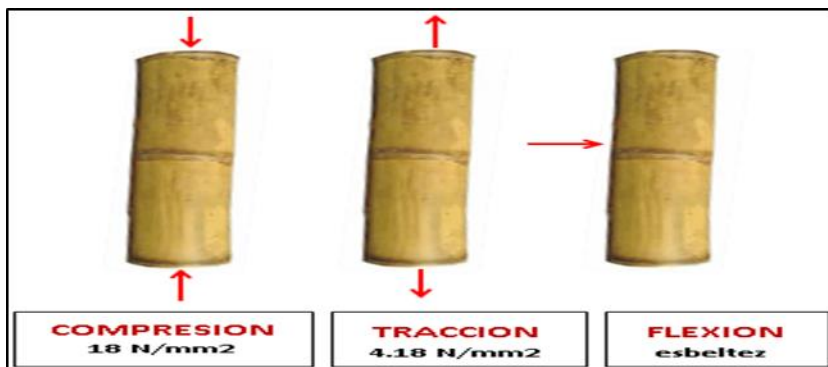
Figura 22. Esfuerzos que soporta la guadua.
