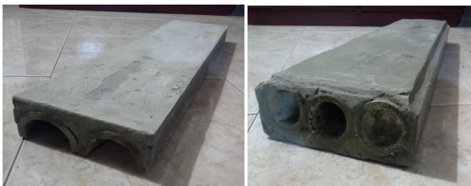
Imagen 13. Paneles tipo I (media guadua) y tipo II (guadua embebida).
