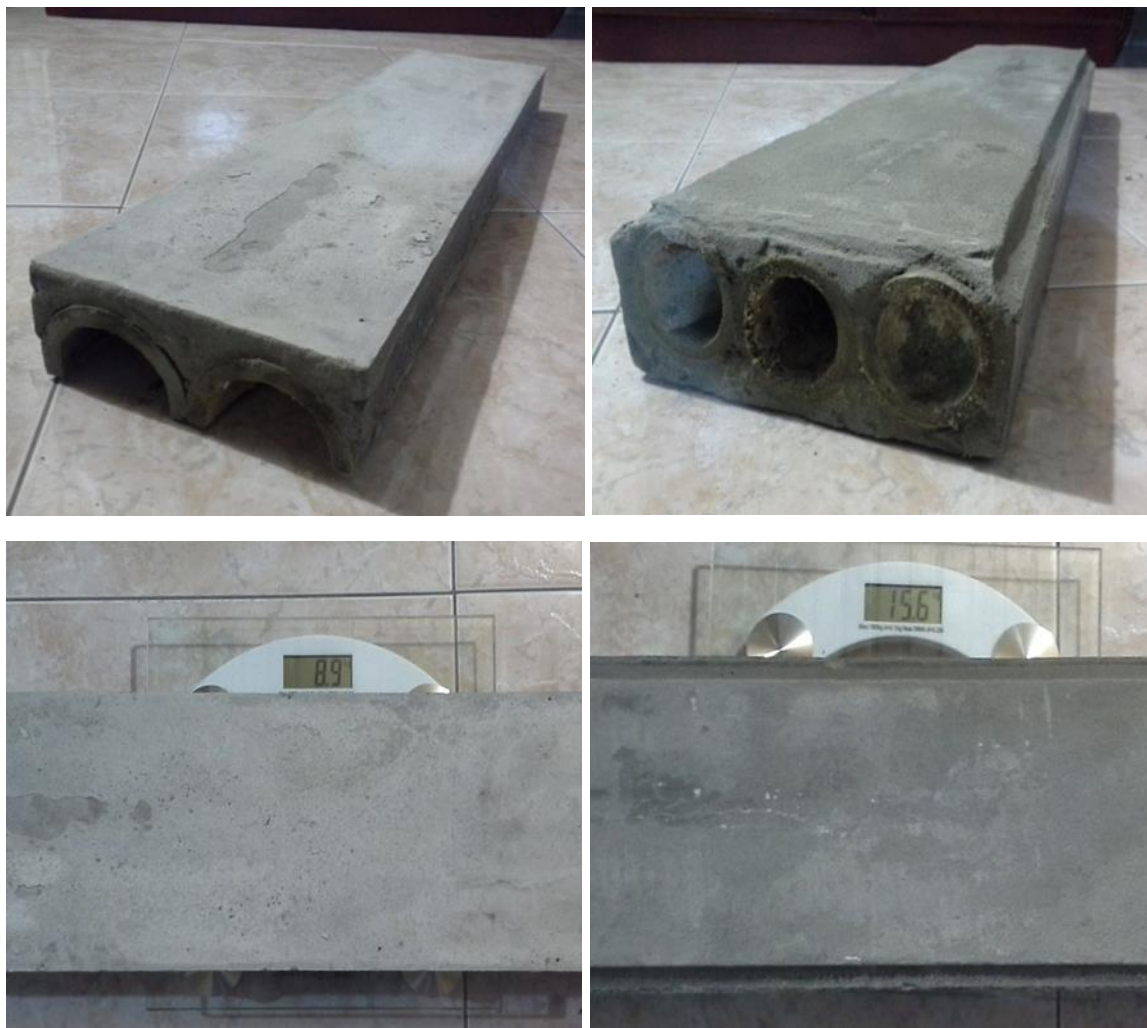
Imagen 18. Peso de paneles tipo I (media Guadua) y tipo II (guadua embebida).
