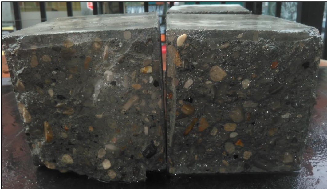
Imagen 39. Planos de Falla Vigüeta 3000-1 (Izquierdo y Derecho)
