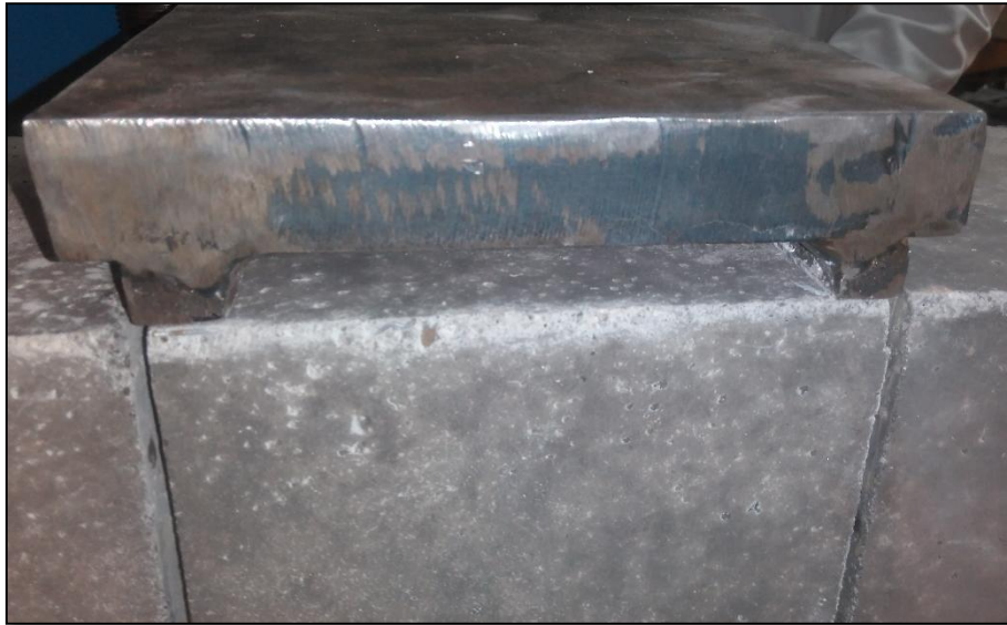
Imagen 36. Desviación de las Ranuras respecto a las Platinas
