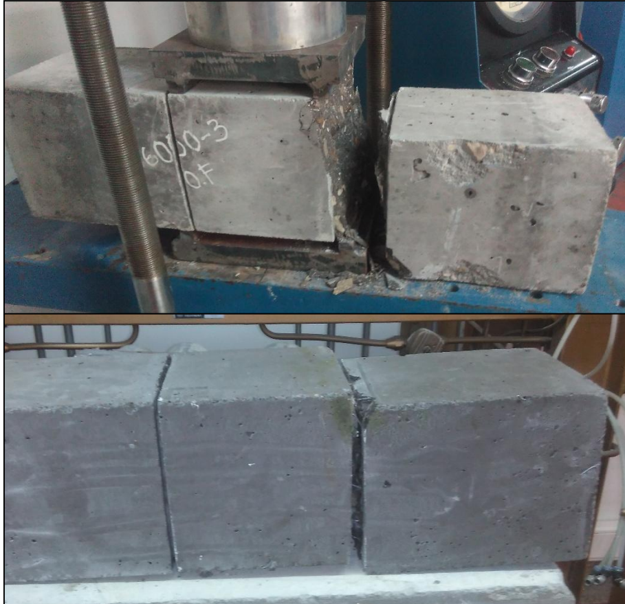
Imagen 41. Plano de Falla a Cortante Puro. Vigüeta con y sin Fibras
