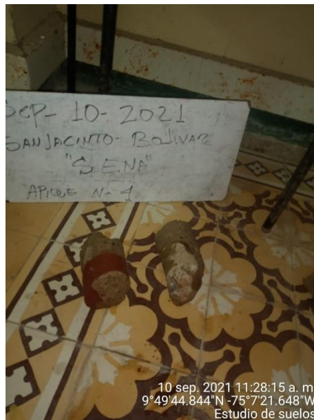
IMAGEN 10 NÚCLEOS EXTRAÍDOS DE LA CIMENTACIÓN 40X39
