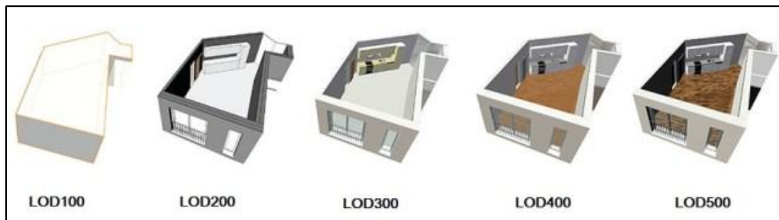
Figura 28. Niveles de detalle BIM.
