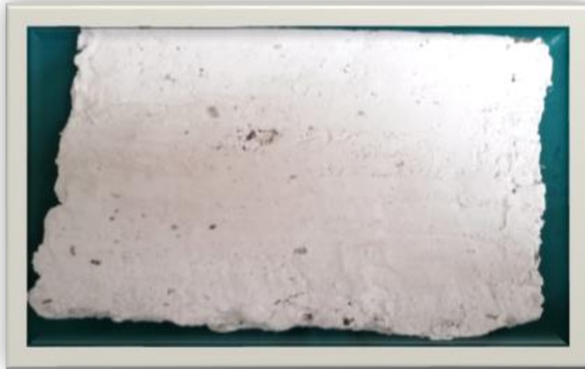
Figura 8. Molde 1. Mezcla de cascara de mani con resina y yeso
