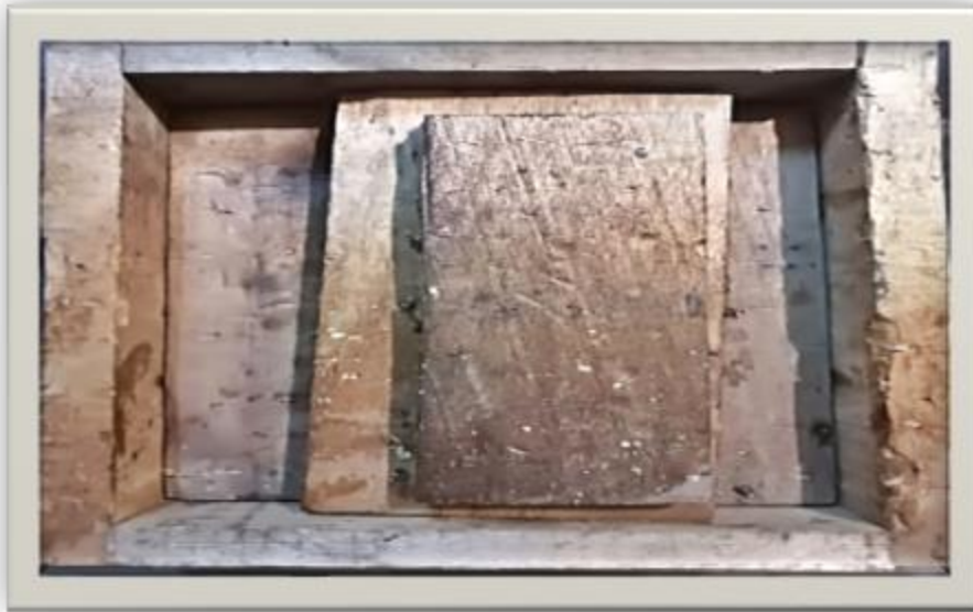
Figura 6. Proceso de prensado molde de madera y molde en vidrio
