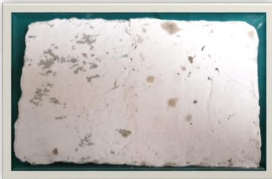
Figura 9. Molde 2. Mezcla de cascara de mani con yeso y estuco
