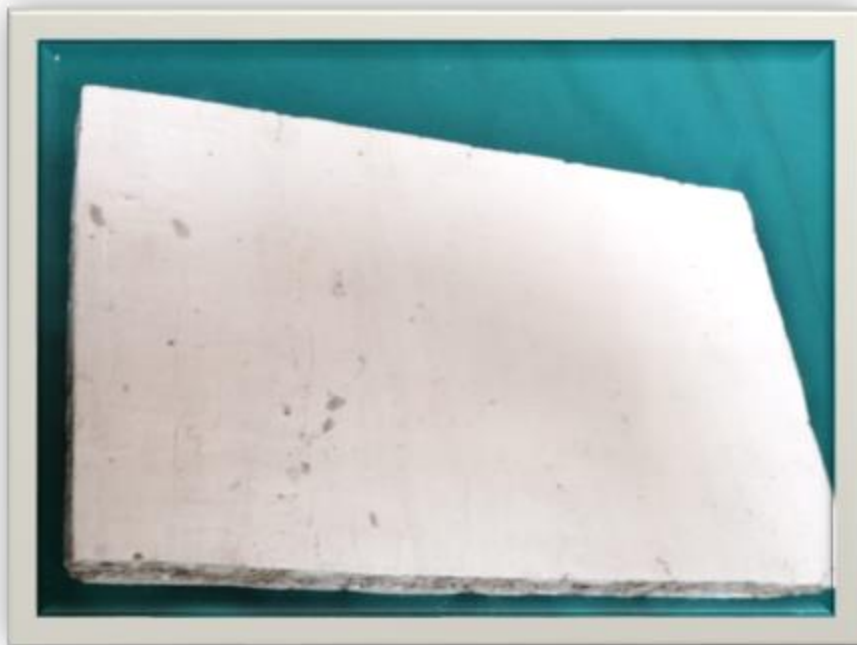
Figura 10. Molde 3. Mezcla de cascara de mani con yeso
