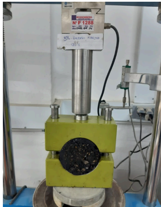
Fotografía 5. Ensayo de estabilidad y flujo Fuente: Elaboración propia.
