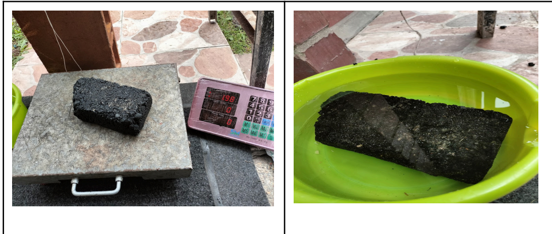
Fotografía 9. Ensayo Absorción de Agua Fuente: Elaboración propia.
