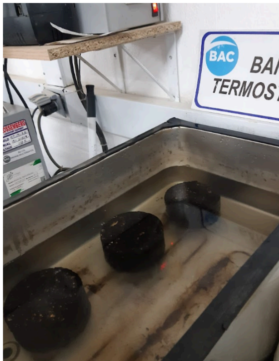
Fotografía 5. Ensayo de estabilidad y flujo Fuente: Elaboración propia.
