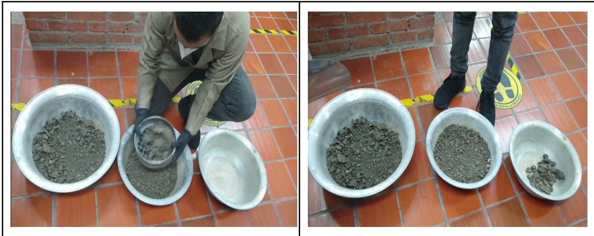
Fotografía 2. Proceso de cuarteo del RAP Fuente: Elaboración propia.
