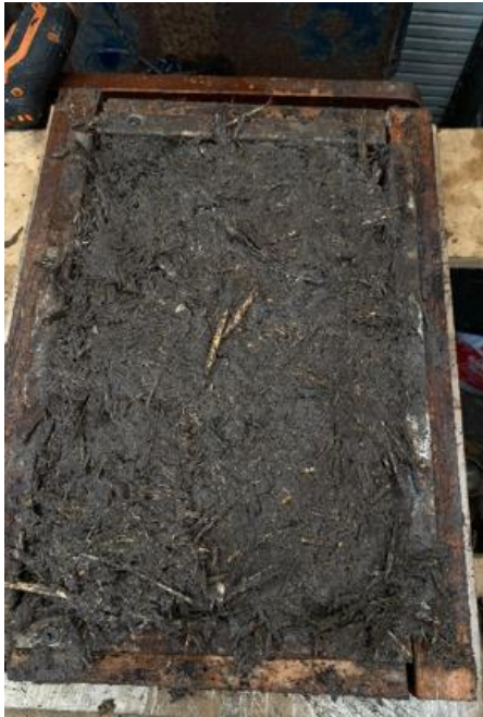
figura 26. Moldeado del panel.
