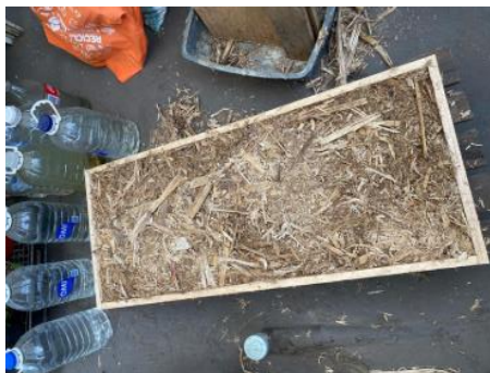
figura 58. Moldeado del panel.
