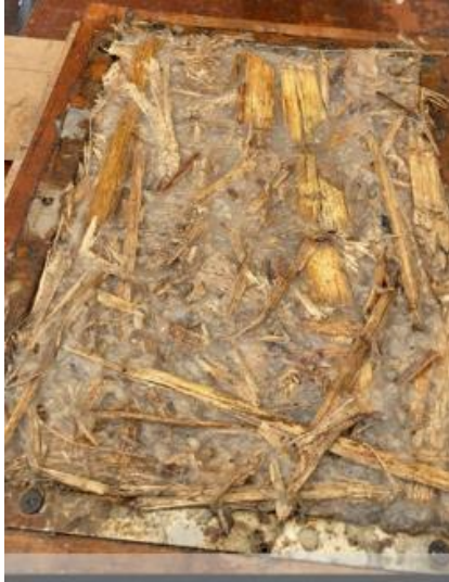
figura 37. Moldeado del panel.
