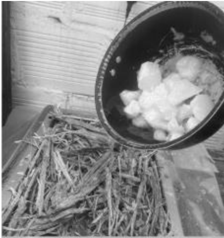
figura 16. Moldeado del panel
