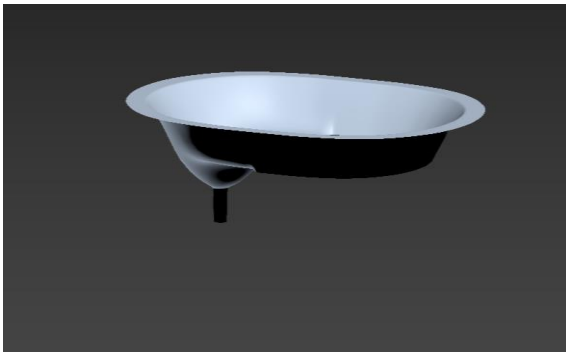
Figura 13. Modelado 3d del separador del sanitario seco. Elaboración propia 3D's Max.
