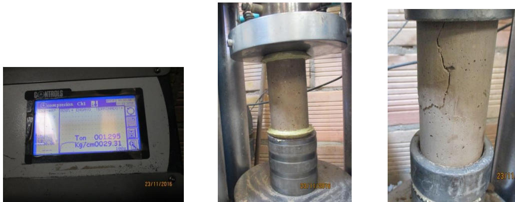
Ilustración 8. Resultado arrojado por la prensa y fallo de cilindros Neopreno y Capín de azufre
