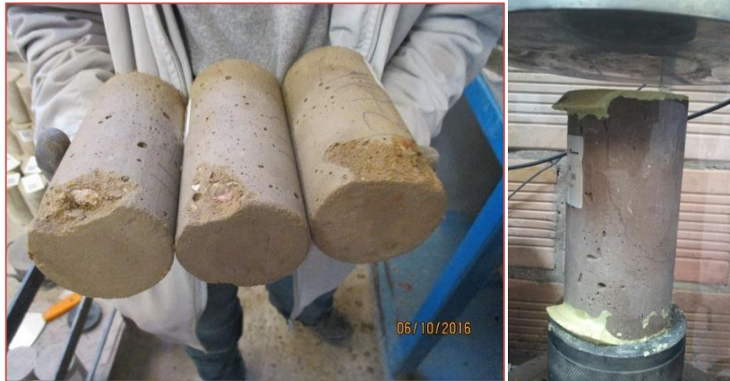
Ilustración 9. Ejemplo de tipo de fallo presentado en el Neopreno y el mortero de Azufre
