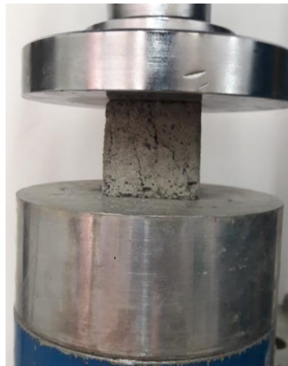
Ilustración 14. Centrado de la probeta ensayo compresión simple.
