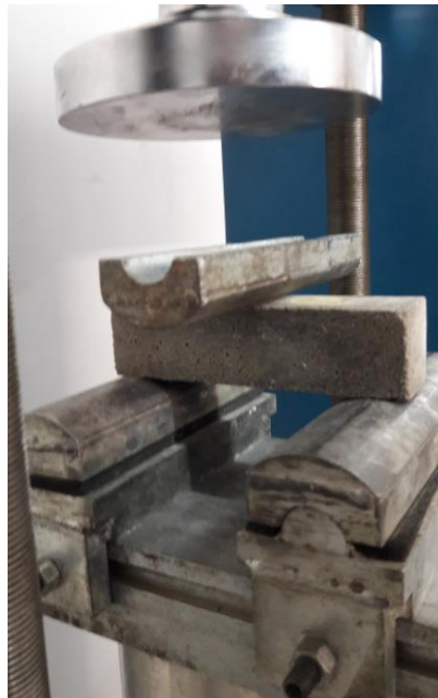
Ilustración 16. Montaje ensayo de flexión.
