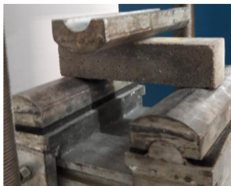
Ilustración 18. Montaje de viga de mortero para ensayo de flexión en morteros.
