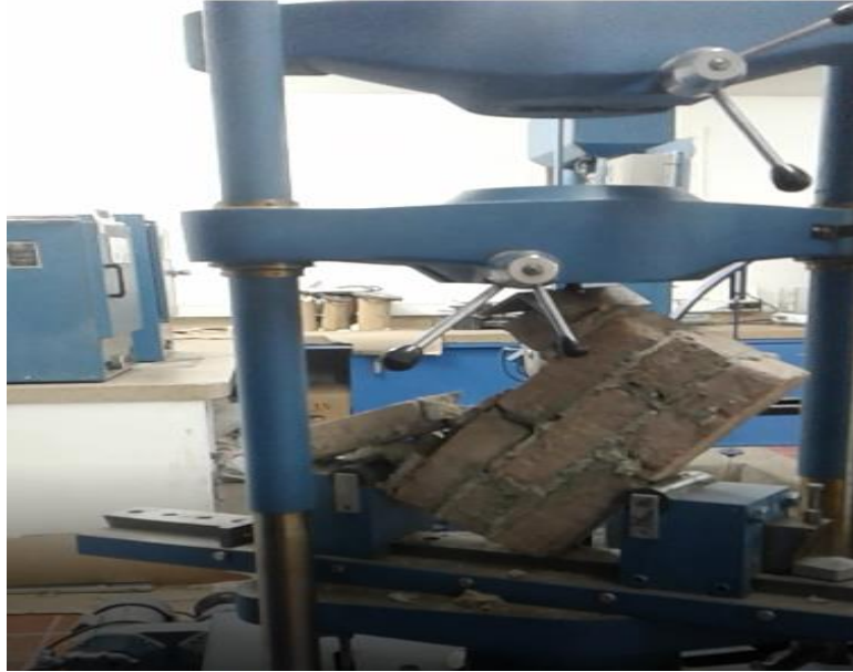
Ilustración 22 murete ensayado a cortante. Fuente: Elaboración propia (2016)
