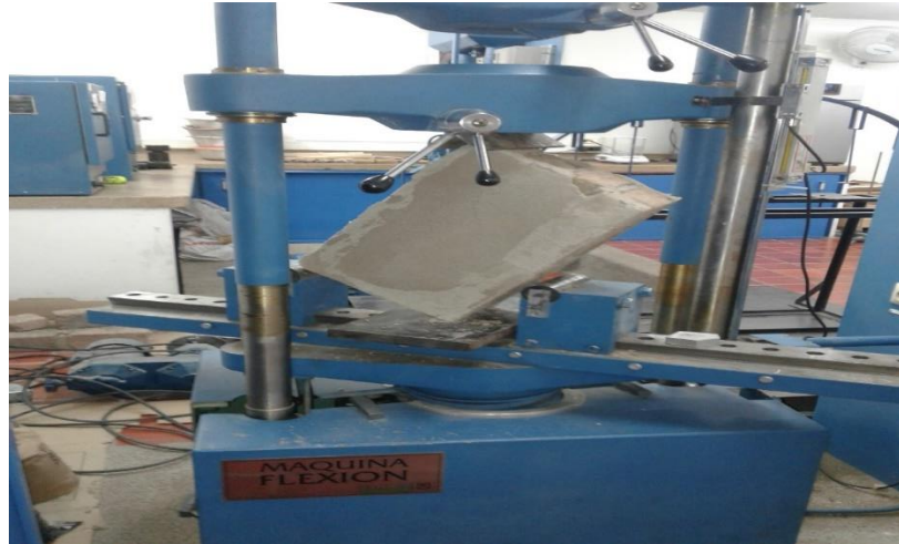
Ilustración 23 murete reforzado con malla electro soldada. Fuente: Elaboración propia (2016)
