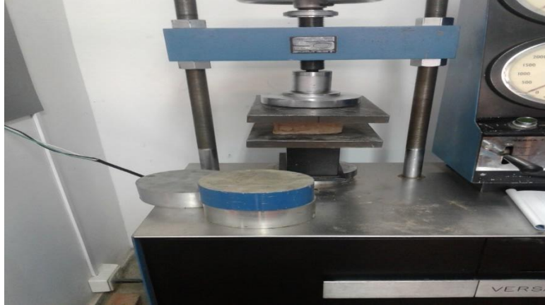
Ilustración 20 ensayo a compresión. Fuente: Elaboración propia (2016)
