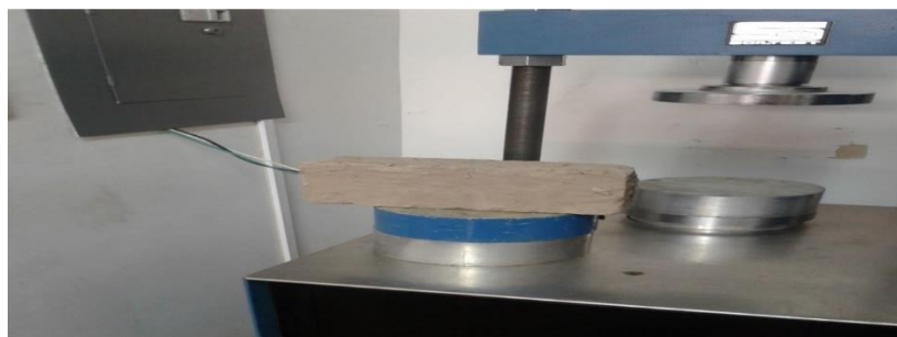
Ilustración 19 adobe a ensayar a compresión. Fuente: Elaboración propia (2016)
