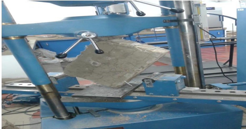
Ilustración 2 murete reforzado con fique. Fuente: Elaboración propia (2016)
