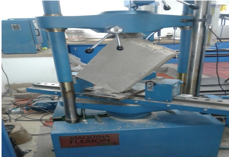
Ilustración 24 murete reforzado con malla vena. Fuente: Elaboración propia (2016)
