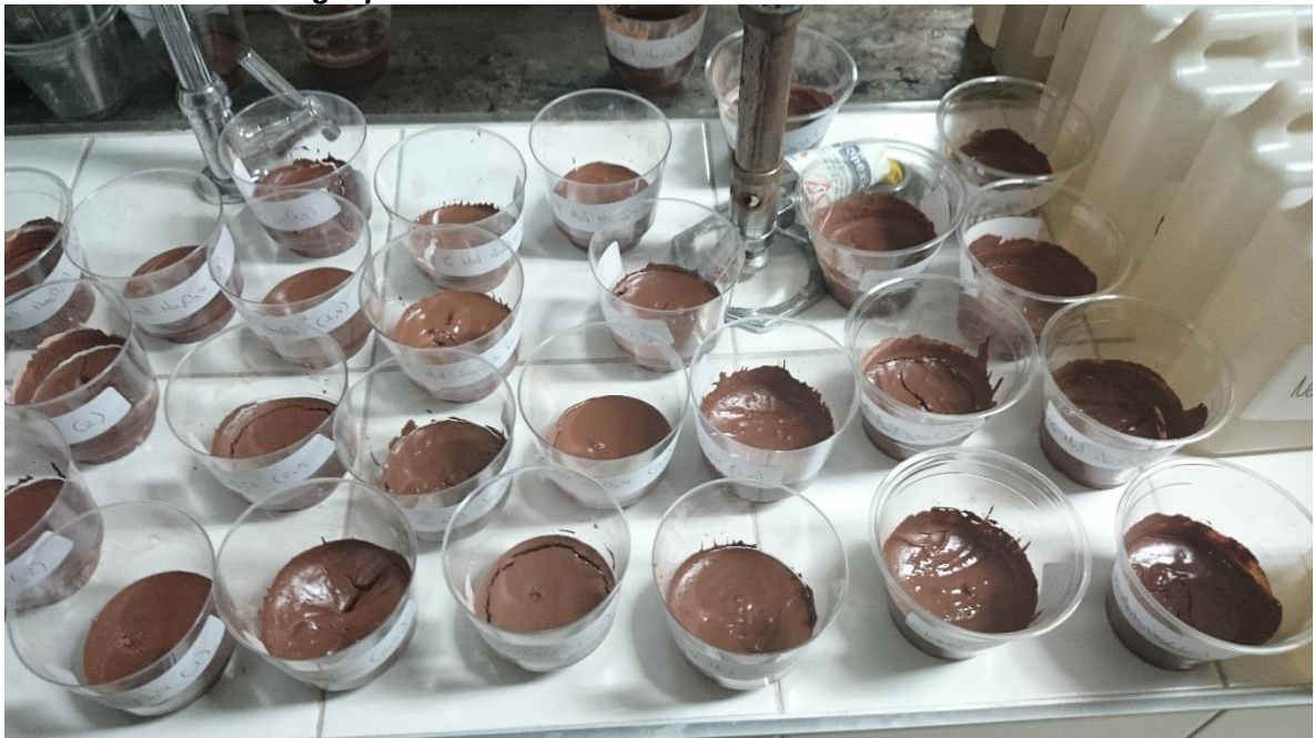
Ilustración 17 Prueba geopolimerización relación 1:1 Activante/Cementante.
