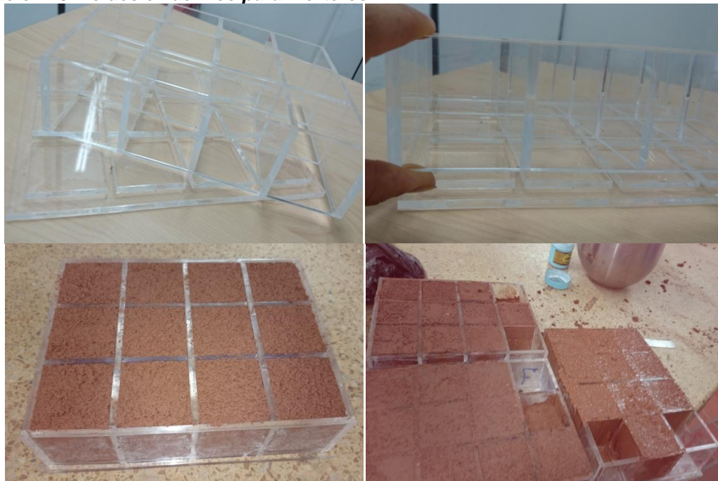
Ilustración 19 Moldes en acrílico para morteros
