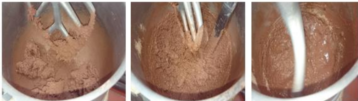
Fuente: Propia. Relación activante/cementante 0.5, 0.7 y 1 (respectivamente).
