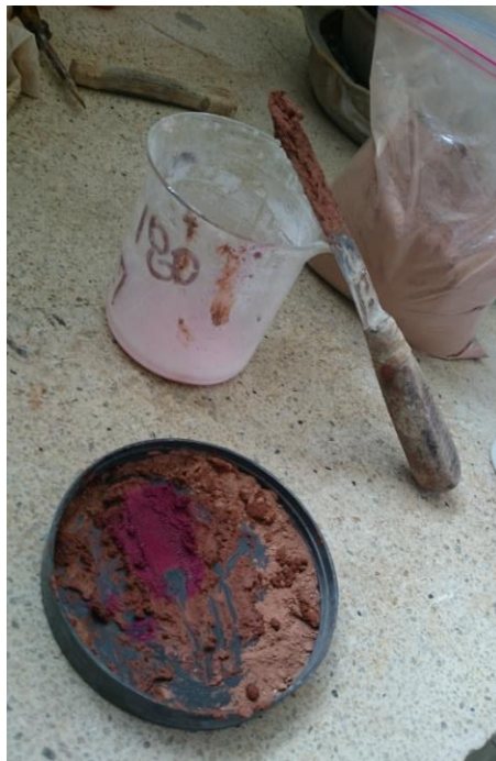
Ilustración 15 Prueba de alcalinidad de la arcilla
