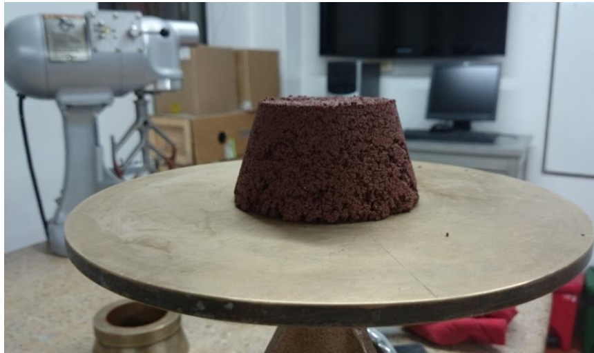
Fuente: Propia. Relación de Activante/cementante a 0.5
