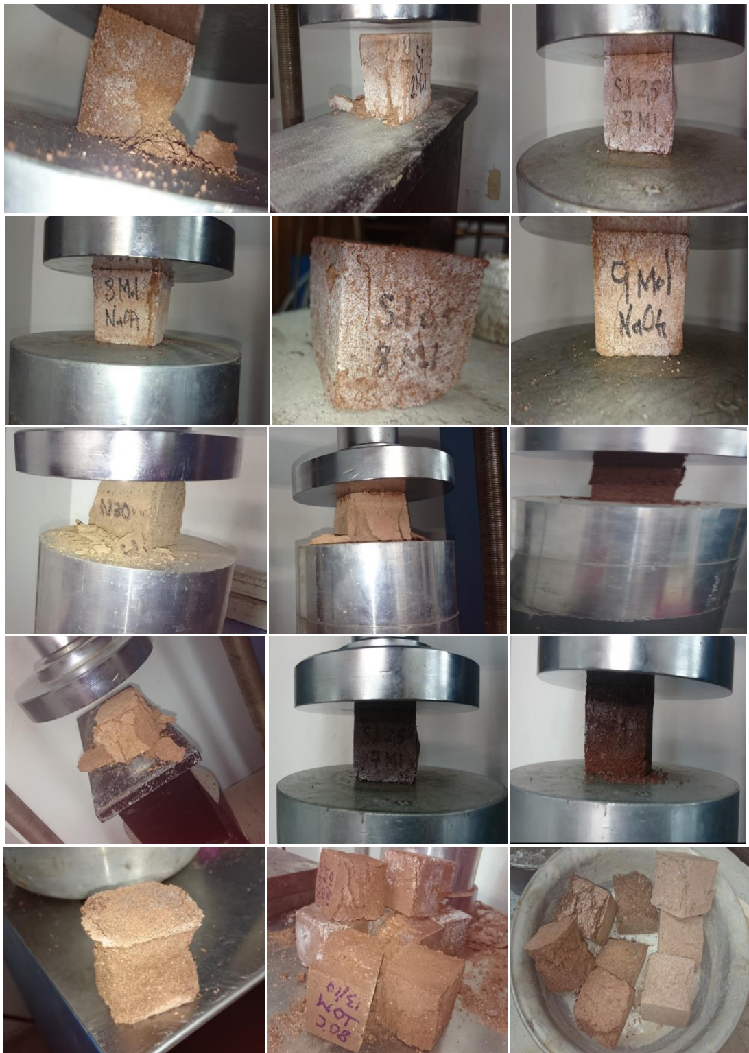
Ilustración 20 Ensayos de Resistencia a la Compresión
