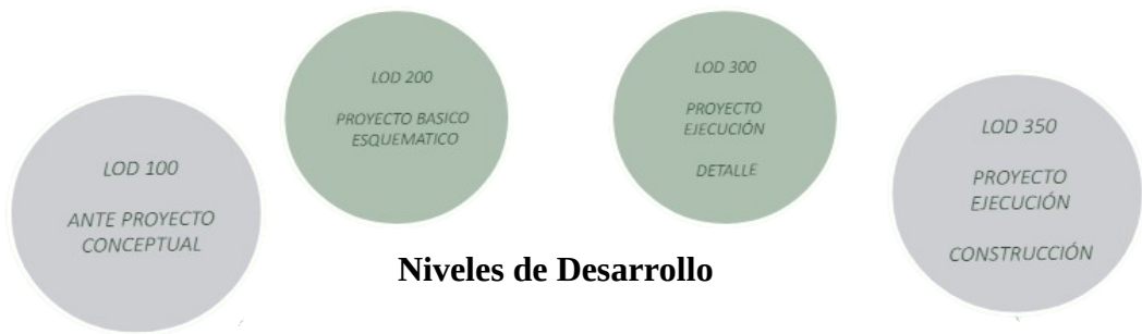
Figura 39 Niveles del BIM
