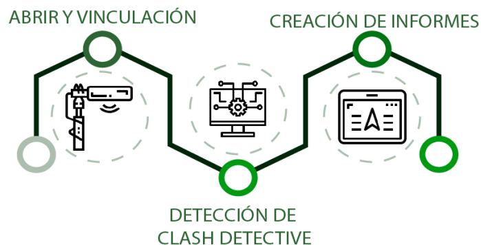
Figura 83 Interferencias e inconsistencias desde Revit
