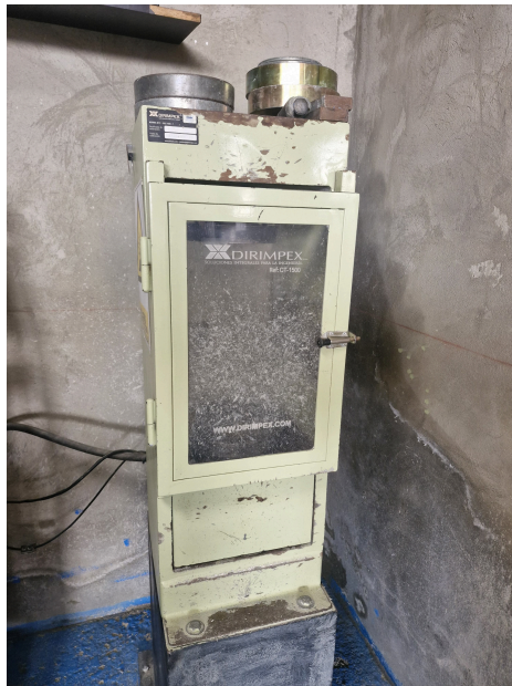
Figura 32 Resistencia a la compresión
