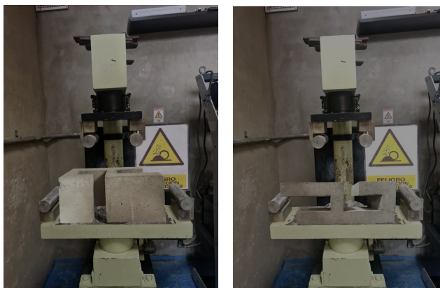
Figura 33 Resistencia a la deformación
