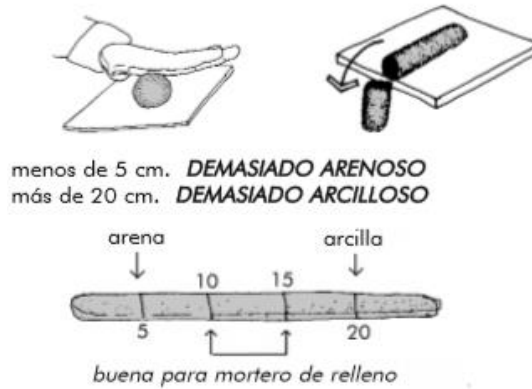
Figura 5. “El cigarrillo”. Prueba que se le realiza a la tierra para identificar las propiedades. Tomado de “W.CyA.R,2002,Guia de construcción parasísmica,p9.Recuperado de https://www.misereor.org/fileadmin/user_upload/misereor_org/Cooperation_Service/spanisch/guia-de-construccion-bahareque-parasismica.pdf ”
