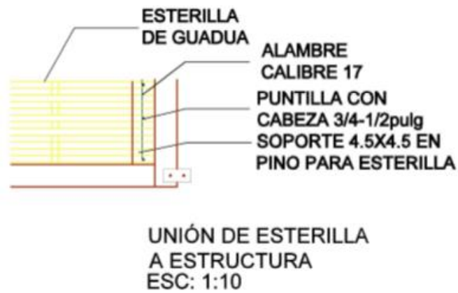
Figura 13:Detalle fijación de esterilla a panel. Elaboración propia
