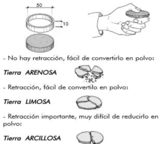
Figura 6. “La pastilla”. Prueba para evaluar la resistencia por ruptura. Tomado de “W.CyA.R,2002,Guia de construcción parasísmica,p9.Recuperado de https://www.misereor.org/fileadmin/user_upload/misereor_org/Cooperation_Service/spanisch/guia-de-construccion-bahareque-parasismica.pdf ”
