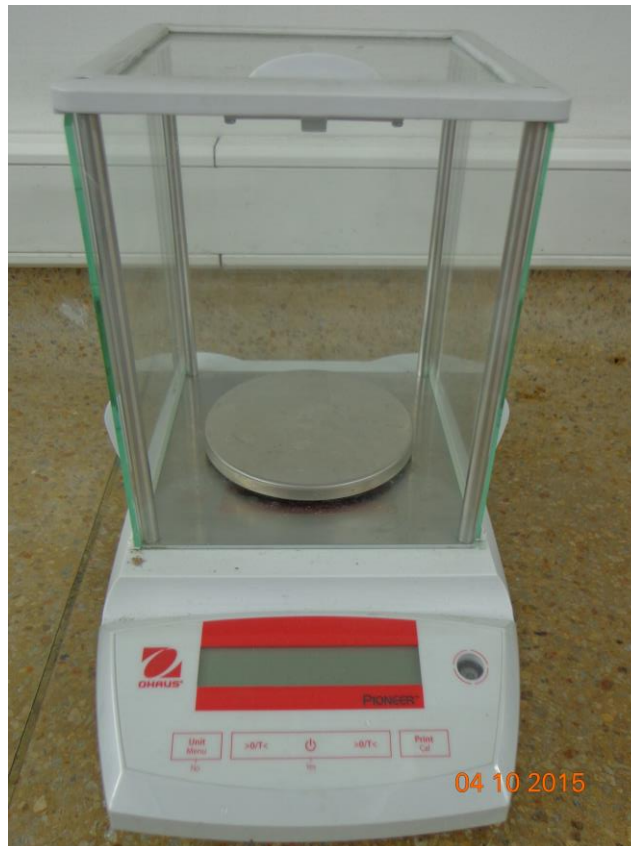
Figura 22. Balanza electrónica para la toma de datos
