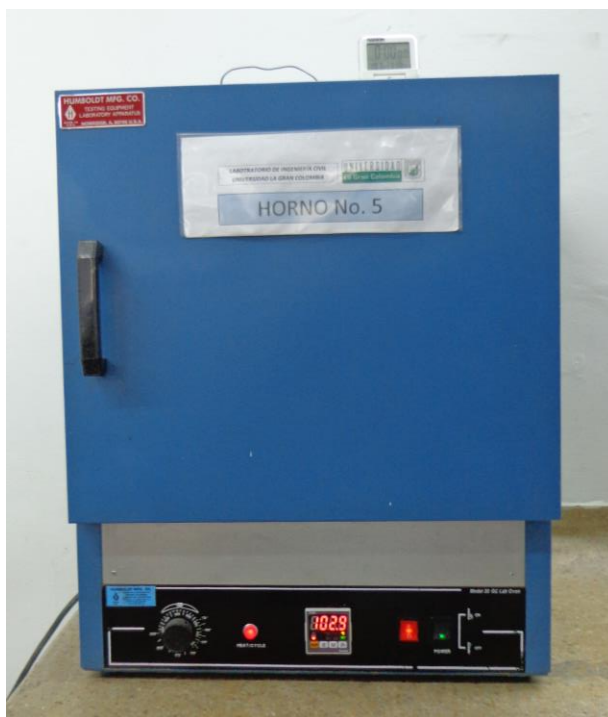
Figura 11. Horno N° 5 utilizado para secar las probetas de guadua angustifolia kunth
