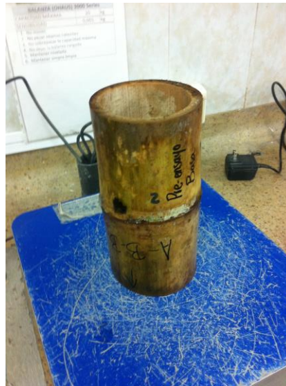
Figura 25. Peso probeta basa con nudo para ser ensayada
