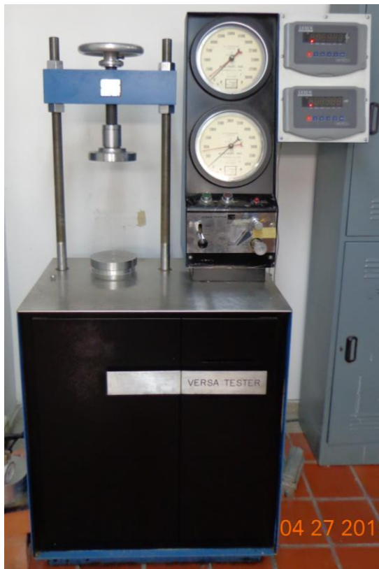
Figura 26. Máquina de ensayos a compresión Versa Tester
