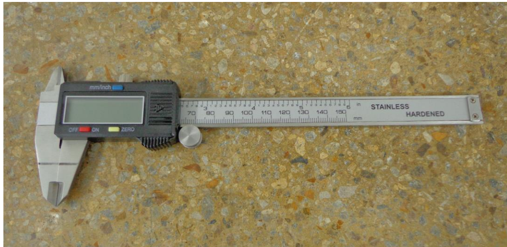
Figura 21. Calibrador vernier digital utilizado en la medición de las dimensiones de las probetas.
