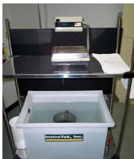
Ilustración 23. Determinación de la masa de la muestra sumergida
