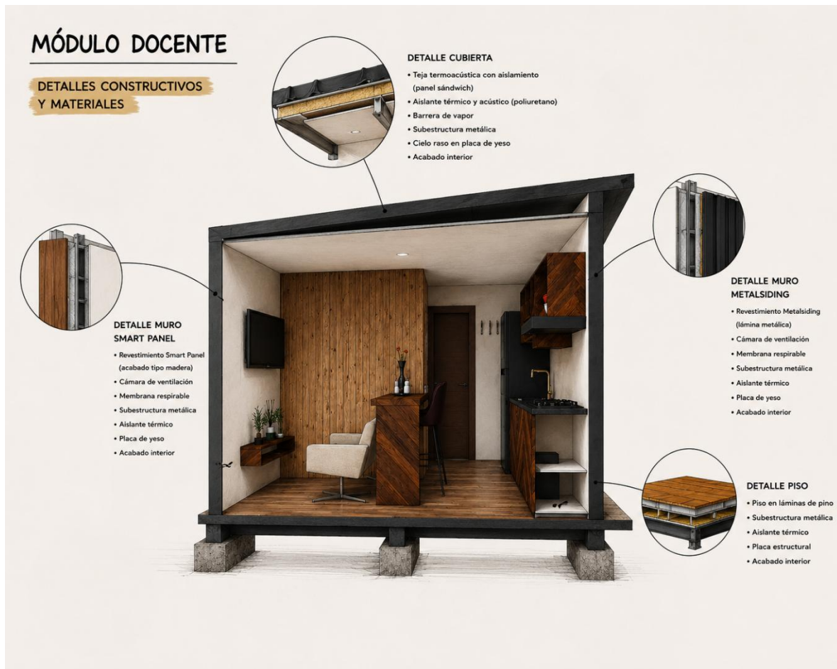
Figura 33 - Detalles constructivos, vista en corte.
