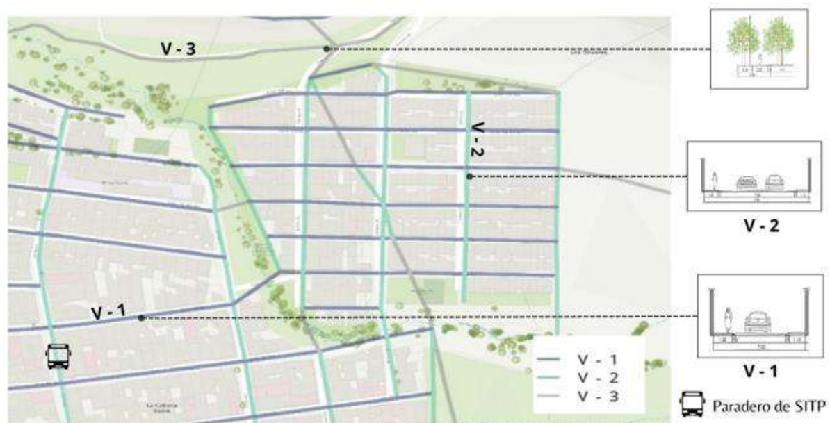
Figura 13 - Análisis de malla vial del barrio Arizona: tipos de vías y sistemas de transporte.
