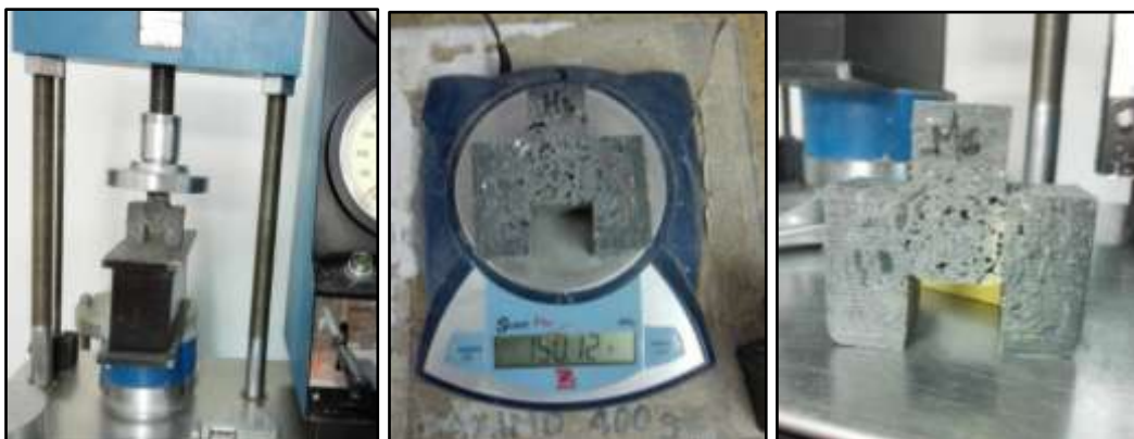
Ilustración 25: Probetas de ensayo para corte
