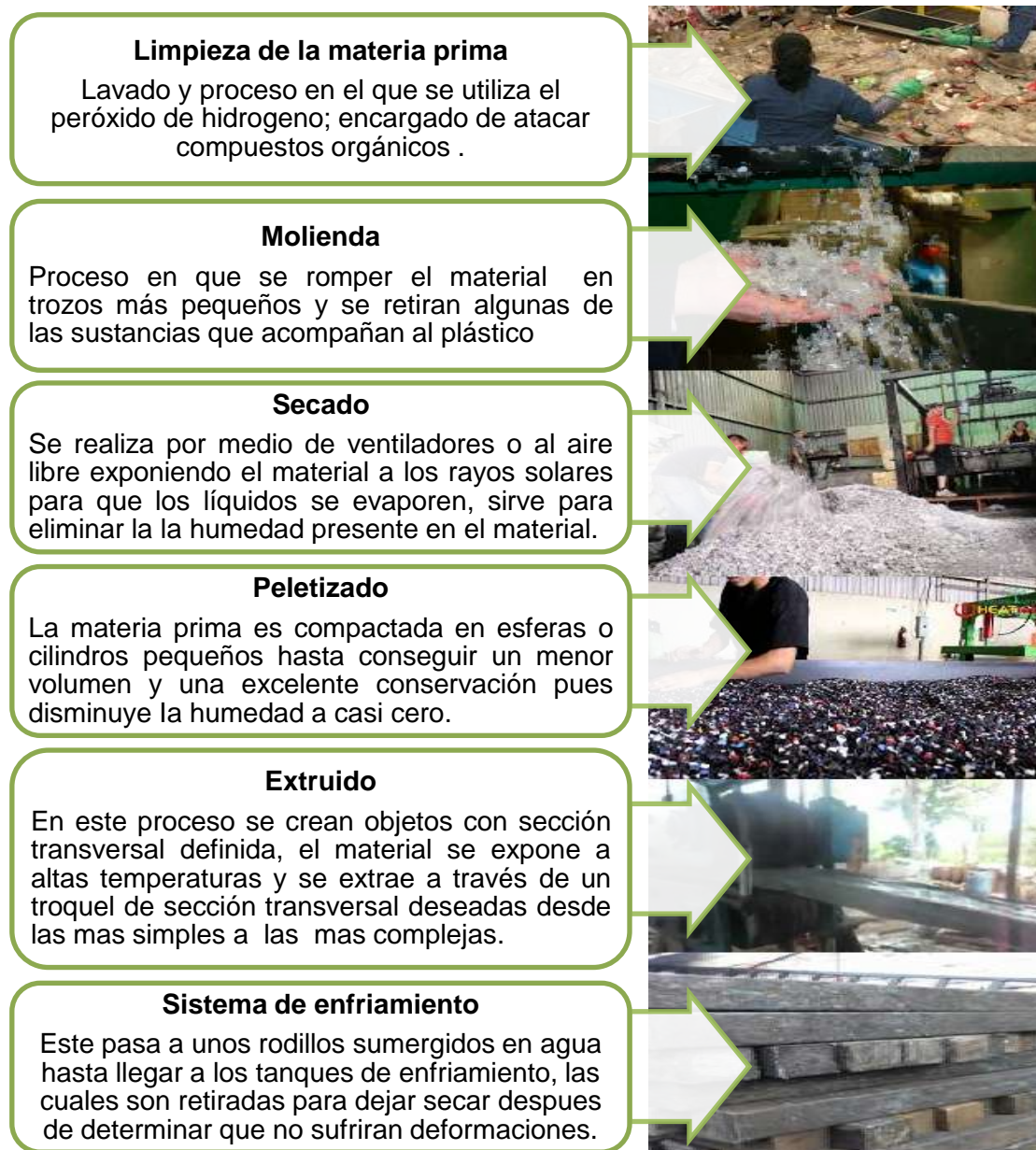
Ilustración 7: Proceso de fabricación de la madera plástica reciclada.
