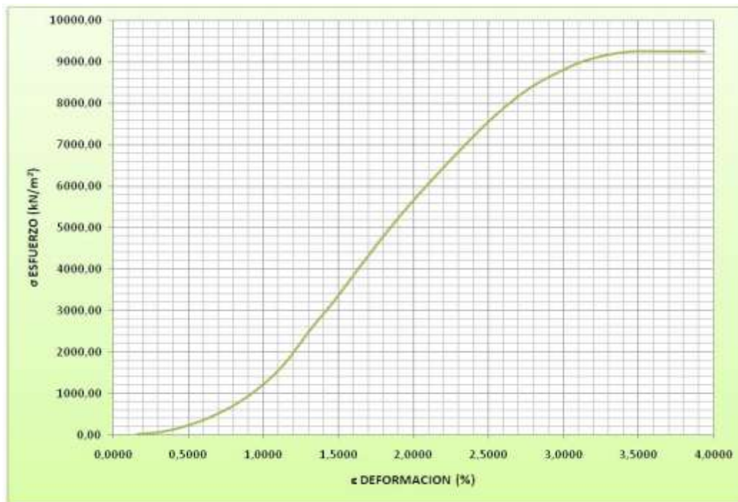
Ilustración 31: Muestras de pandeo–Curva de esfuerzo Vs Deformación.
