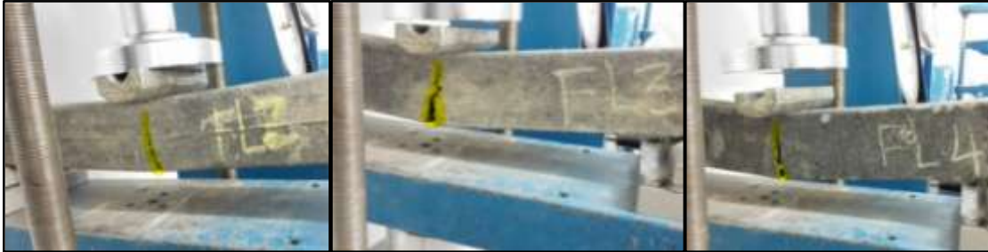
Ilustración 38: Tipo de falla para probetas de plástico reciclado Flexión.
