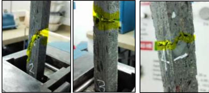
Ilustración 35: Tipo de falla para probetas de plástico reciclado en Tracción
