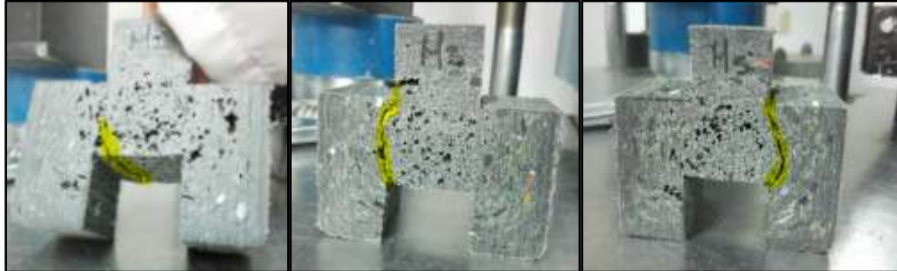
Ilustración 41: Tipo de falla para probetas de plástico reciclado en corte
