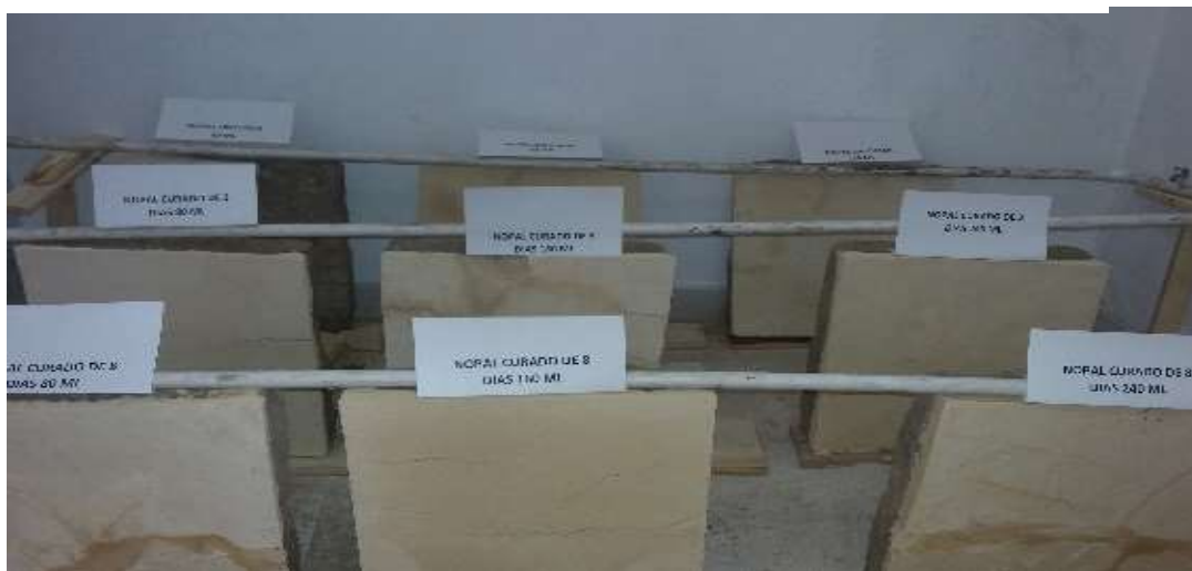
Figura 27 Adaptación de elementos para ensayo de la prueba de goteo para muretes de 40x40
