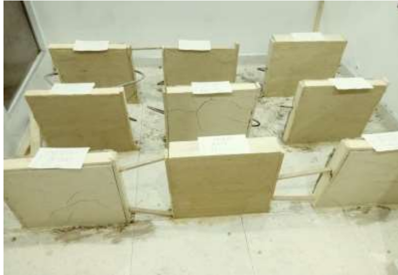
Figura 24 Elaboración de 9 muros de adobe de 40x40, Elaboración propia.
