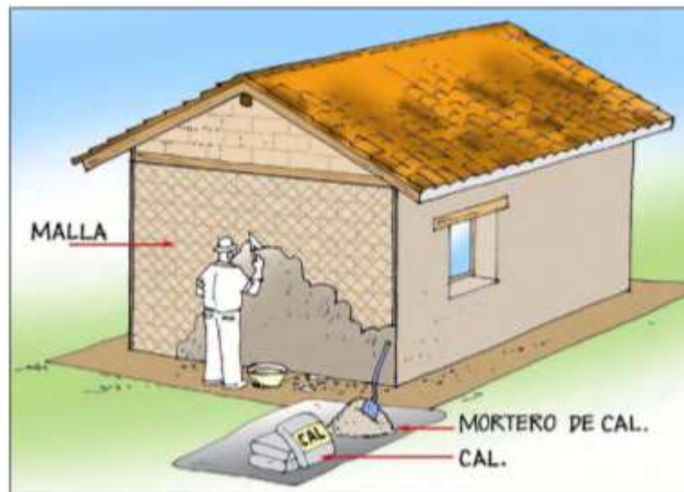
Figura 19. Rehabilitación de revoques de muros; tomado de Asociación Colombiana de Ingeniería Sísmica – AIS (s.f) https://upload.wikimedia.org
