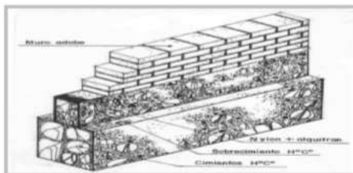
Figura 15. Muro de adobe para impermeabilizante, tomado de manual de autoconstrucción de unidades habitacionales con adobe; república de Bolivia, https://vivienda.oopp.gob.bo
