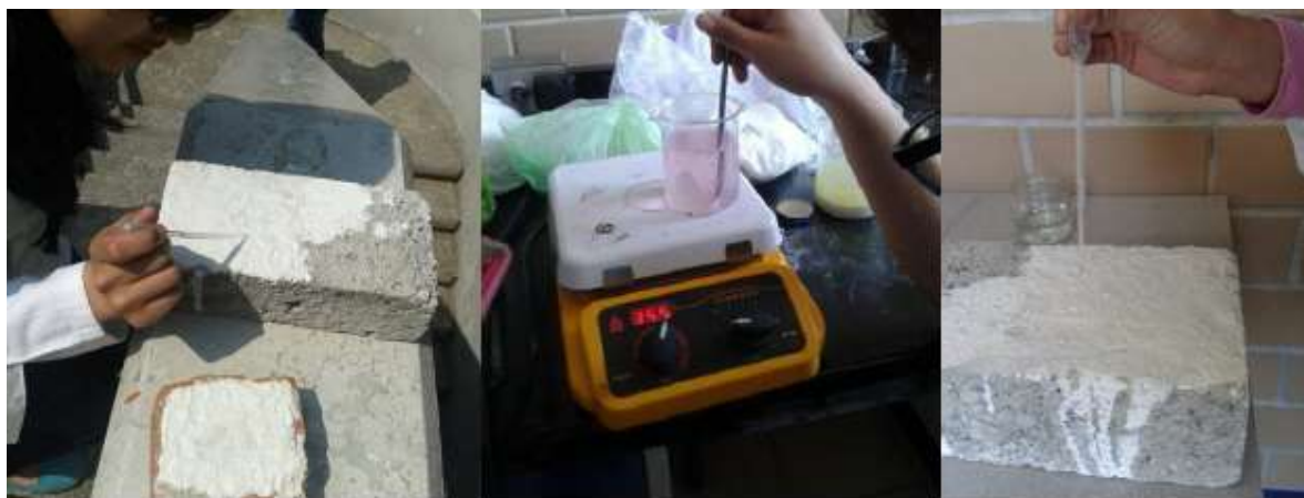
Figura 8.: Proceso de extracción del mucilago o baba de nopal como impermeabilizante de pintura tomado de Universidad Autónoma de México (s.f) https://feriadelasciencias.unam.mx
