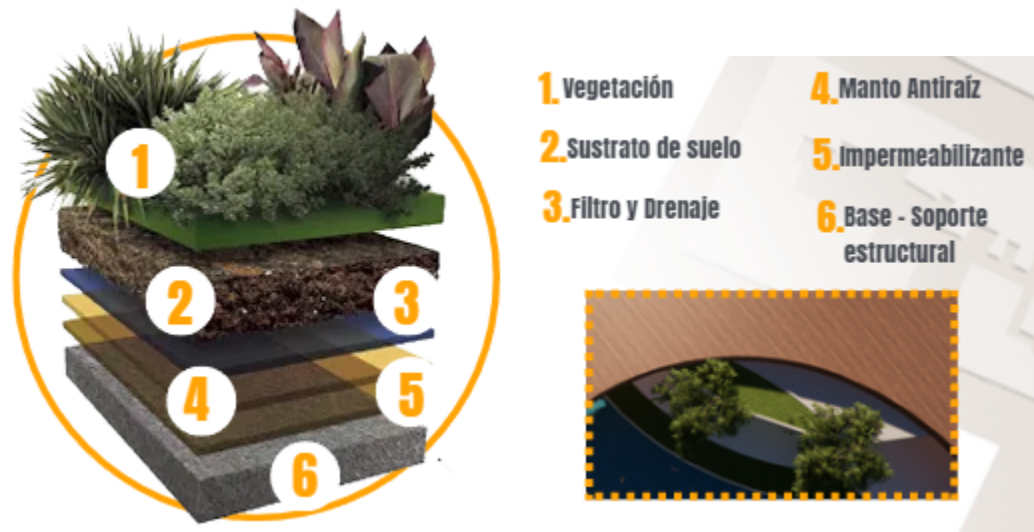
Figura No. 38 Cubierta verde
