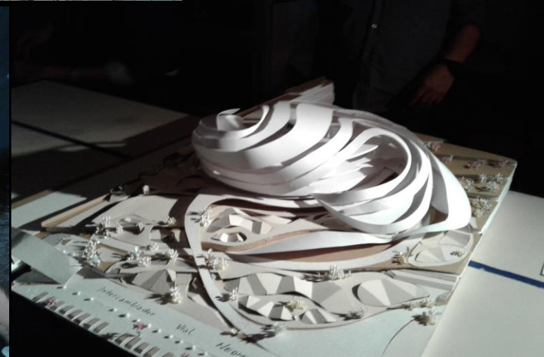
PASO POR EL HELIODON, VERIFICACIÓN DE ASOLEACIÓN
