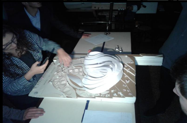
PASO POR EL HELIODON, VERIFICACIÓN DE ASOLEACIÓN
