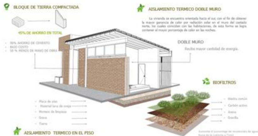
Figura 43. Muro doble. Elaboración propia.
