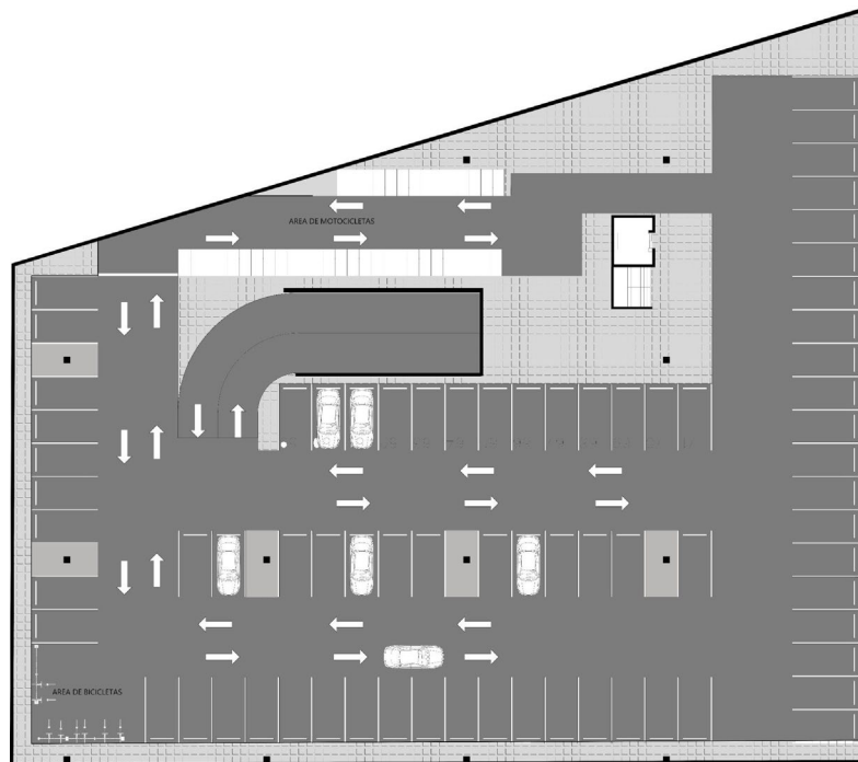
Figura 55 Planta de Sótano
