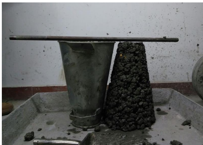
Figura No. 11 Prueba de asentamiento
