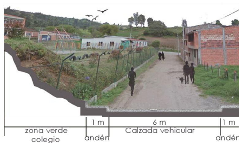
Figura 24 Perfil vial calle 2 sur, vía transitada actual en mal estado. Elaboración propia
