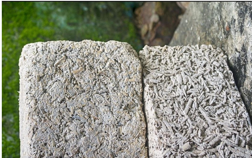
Figura 15 Bloque de hempcrete o concreto de cáñamo
