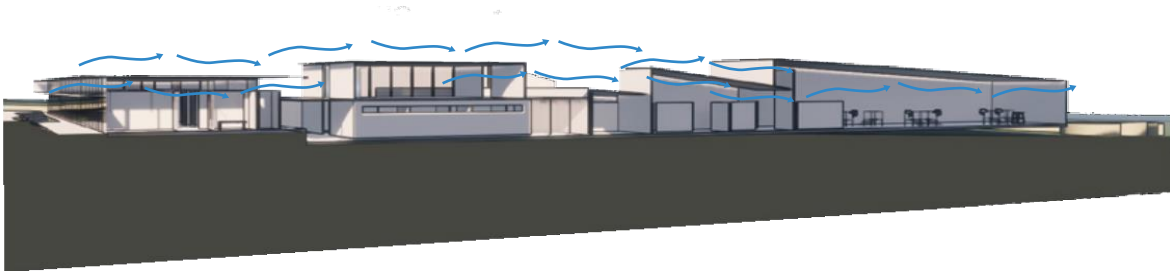
Figura 53. Corrientes de aire, usadas y aprovechadas para el área de producción. Elaboración propia
